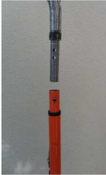
Figura 48. Acoplamiento del subensamble SOPORTE con mango telescópico. Fuente: El Tesista.
