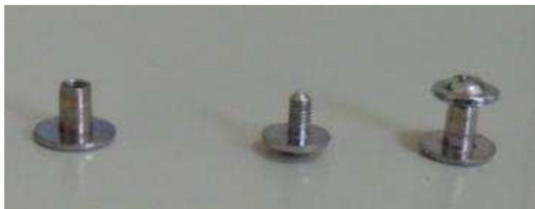
Figura 44. Remaches roscados para sujeción de la canastilla. Fuente: El Tesista.
