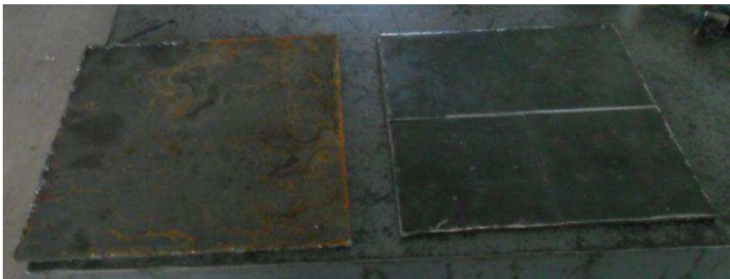
Figura 32. Placas de acero A-36. Fuente: El Tesista.
