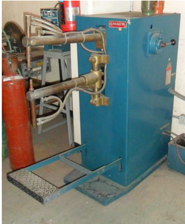
Figura 20. Soldadora de puntos. Fuente: El Tesista.
