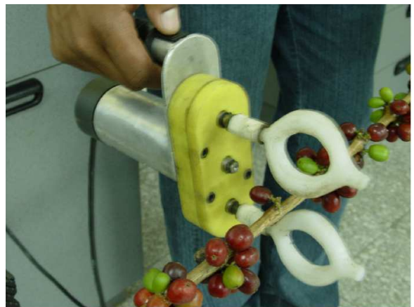
Figura 3. Dispositivo portátil para cosechar café (Oliveros et al., 2005).
