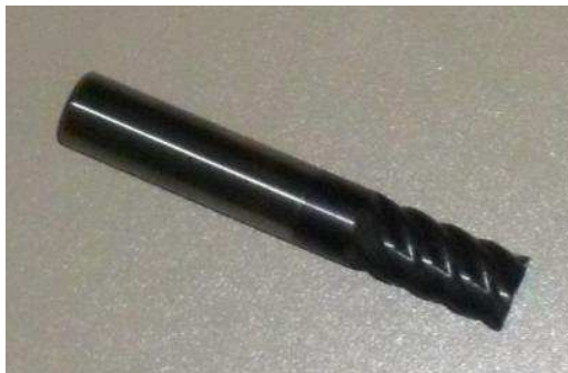
Figura 12. Cortador con recubrimiento de Nitruro. Fuente: El Tesista.
