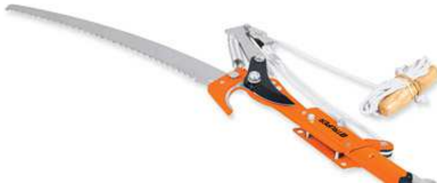
Figura 6. Cortador de ramas altas (Marbletoolsupply, 2012).
