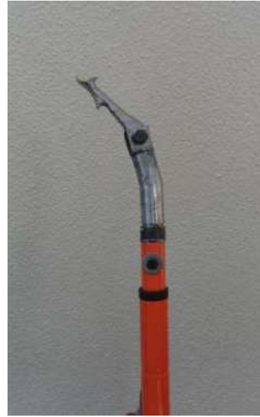
Figura 49. Ensamblado de mango telescópico, SOPORTE y el CORTADOR. Fuente: El Tesista.
