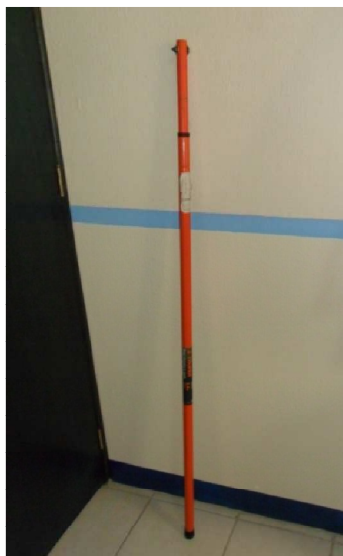
Figura 47. Mango telescópico de aluminio. Fuente: El Tesista.
