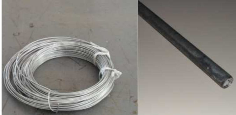
Figura 39. Alambre y tubo galvanizado. Fuente: El Tesista.
