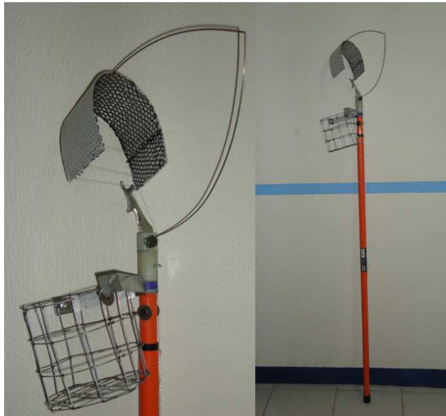
Figura 53. Herramienta para el corte de pitaya ( Stenocereus pruinosus ). Fuente: El Tesista.
