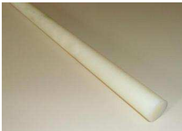
Figura 52. Barra redonda de Nylamid tipo M. Fuente: El Tesista.
