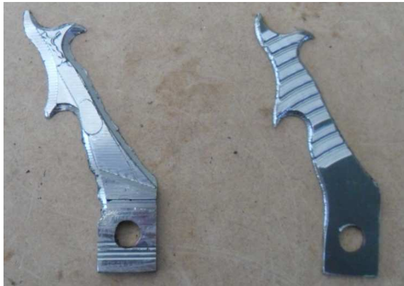
Figura 33. Modelos del Cortador elaborados con acero A-36. Fuente: El Tesista.
