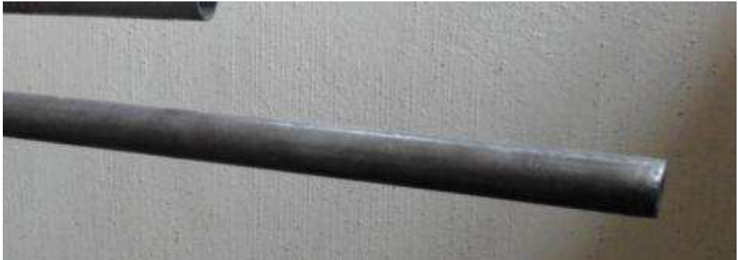
Figura 35. Barra de acero 1018. Fuente: El Tesista.
