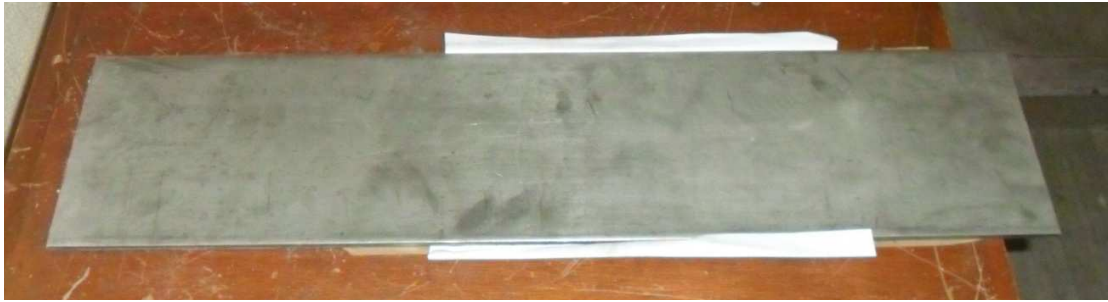
Figura 51. Placa de Acero Inoxidable 304. Fuente: El Tesista.
