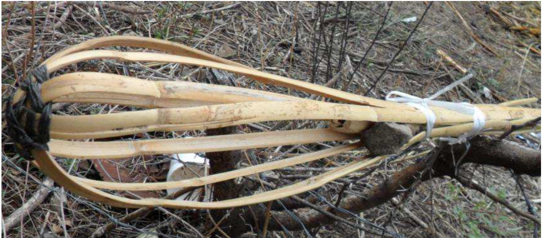
Figura 10. Chicole , herramienta artesanal para el corte de la pitaya.
