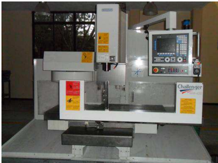
Figura 18. Fresadora CNC. Fuente: El Tesista.
