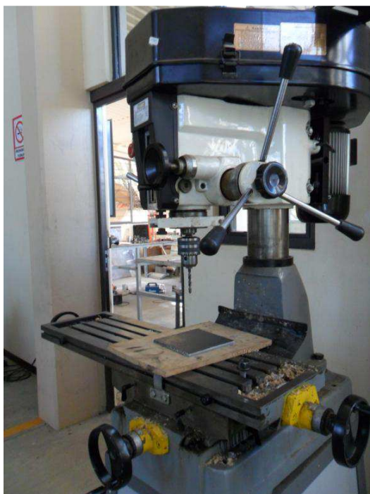
Figura 19. Taladro-fresador. Fuente: El Tesista.
