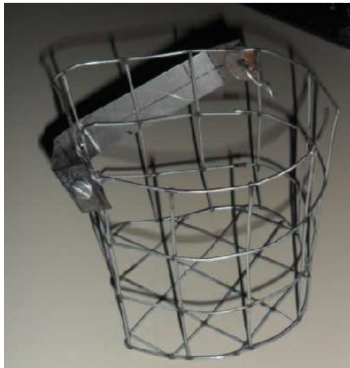
Figura 43. Canastilla elaborada con alambre galvanizado. Fuente: El Tesista.
