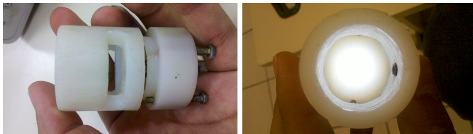
Figura 3.13: Sistema de iluminación a contraluz.
