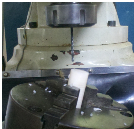
Figura 3.10: Pieza porta ventana de zafiro montada en la fresa vertical y el cabezal divisor
