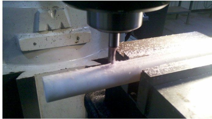
Figura 3.9: Maquinado de la pieza soporte de la lente en la fresadora manual vertical
