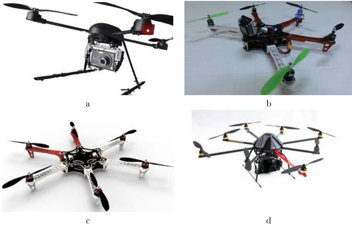
Figura 1.8: Variaciones de Helicópteros: (a) tricóptero ; (b) Pentacóptero ; (c) Hexacóptero ; (d) Octacóptero
