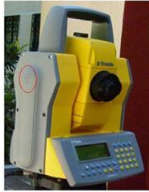
Figura 74 Marca de referencia de la estación total para medir su altura.
