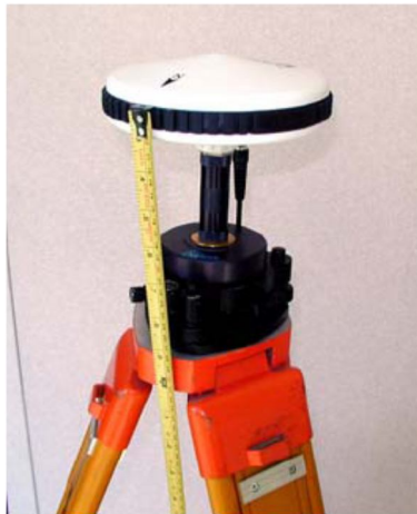
Figura 66 Medición de antena GPS con respecto al piso.
