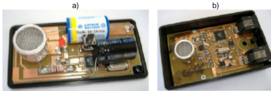
Figura 9 Componentes de un sistema basado en ultrasonido a) Tag ultrasonico y b) Listener ultrasonico.
