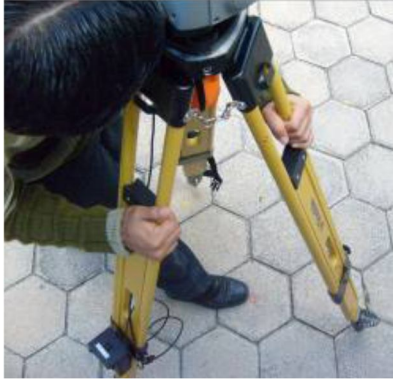
Figura 64 Nivelación de trípode sobre punto de control. Figura 65 Instalación de equipo GPS sobre trípode.
