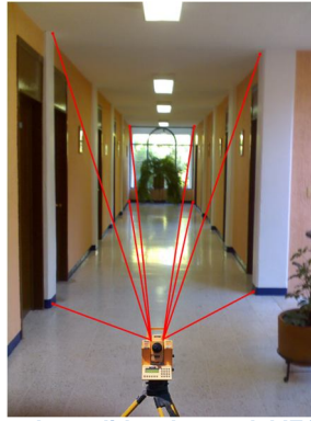
Figura 77 Ejemplo de toma de medidas dentro del IEC usando la estación total.
