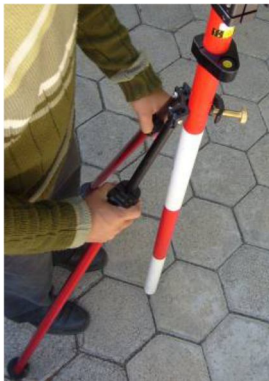
Figura 78 Nivelación de trípode de primas.
