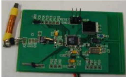
Figura 13 Transponder, compuesto por una antena férrea, micro ATmega88, receptor MAS9180 y transceptor CC2500.
