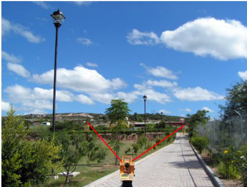
Figura 62 Ejemplo de visibilidad entre estación total y prisma (ausencia de obstáculos que bloqueen el láser).
