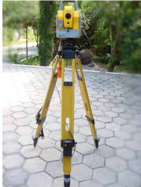
Figura 73 Instalación de equipo de la estación total sobre trípode.
