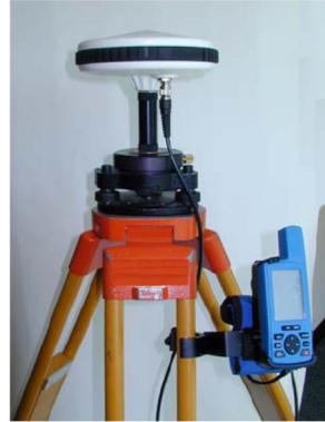
Figura 64 Nivelación de trípode sobre punto de control. Figura 65 Instalación de equipo GPS sobre trípode.
