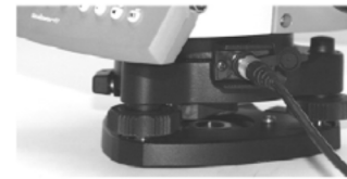
Figura 75 Conexión de la estación total a la batería.
