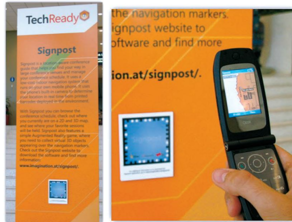
Figura 32 Marcador de Marco Der) Colocado en un cartel de Microsoft's TechReady7 e Izq) Identificación y lectura del marcador por medio del sistema Singpost.
