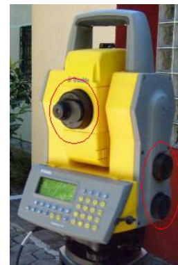
Figura 80 Mirilla y perillas de ajuste vertical y horizontal de la estación total.
