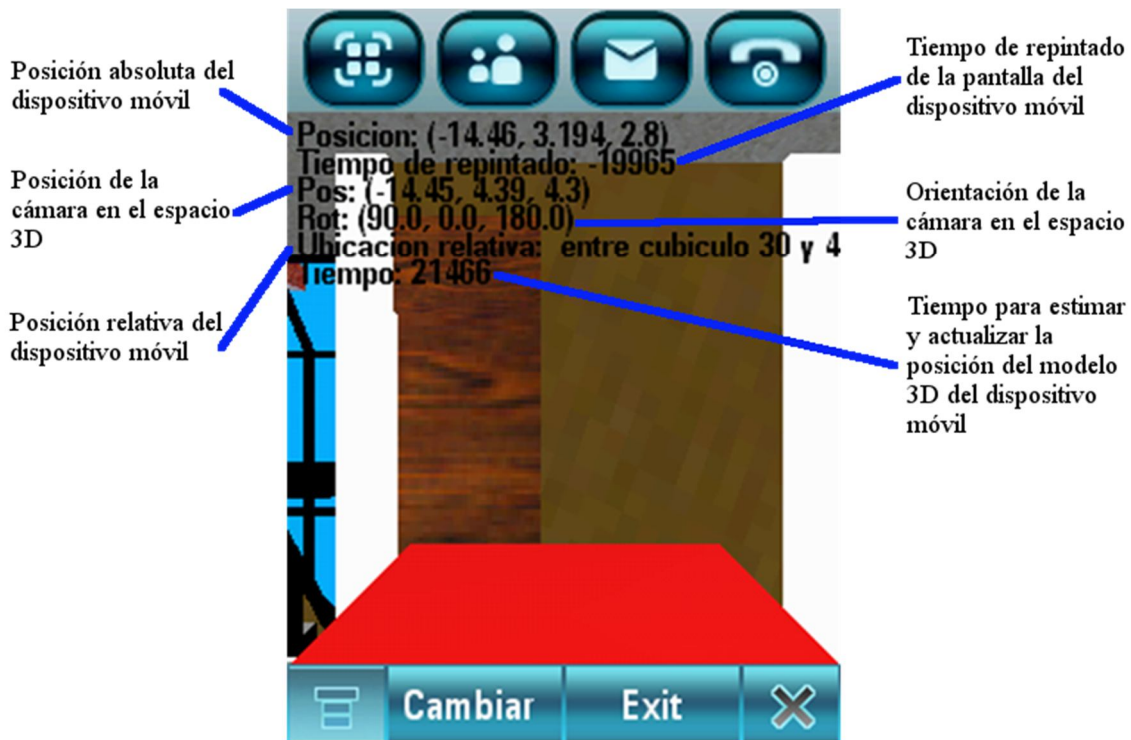
Figura 107 Imagen correspondiente a la pantalla de la aplicación de la terminal móvil en la cual se muestra la información adicional con que se cuenta al momento que el sistema realiza la localización del propio dispositivo.
