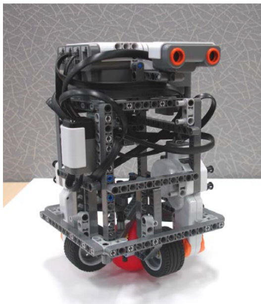
Figura 1.11: Prototipo NXT ballbot desarrollado por Yori-hisa Yamamoto y basado en el ballbot de Ralph Hollis. Imagen tomada de [78].
