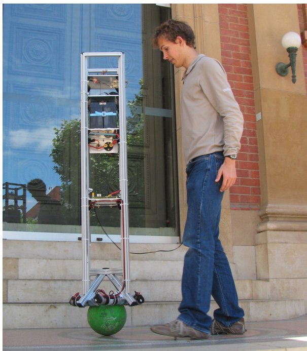
Figura 1.5: Ballbot desarrollado por Justin Fong y Simon Uppill en la Universidad de Adelaide. Imagen tomada de http://sites.mecheng.adelaide.edu.au/robotics/robotics_projects.php?wpage_id=44&title=61&browsebyyear=2009 .
