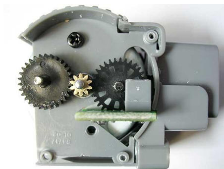
Figura 3.9: Vista del encoder interno en el motor. Imagen tomada de [34].
