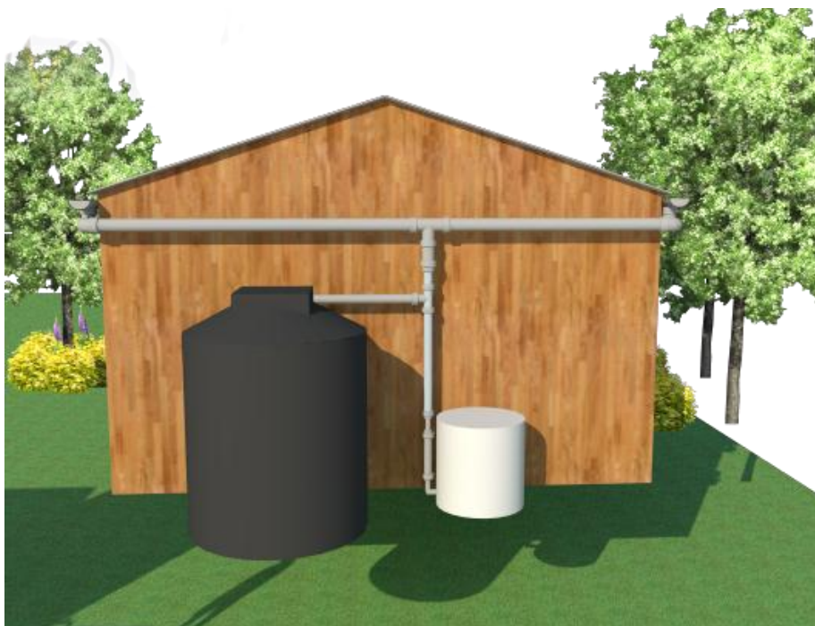
Imagen 5.37 Implementación de tanque superficial.
