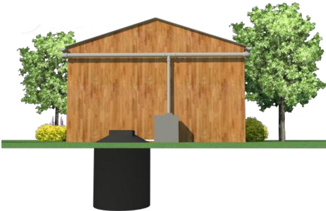
Imagen 5.35 Implementación del tanque enterrado.
