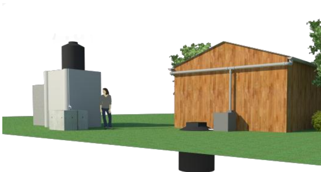
Imagen 5.38 Implementación de tanque enterrado.
