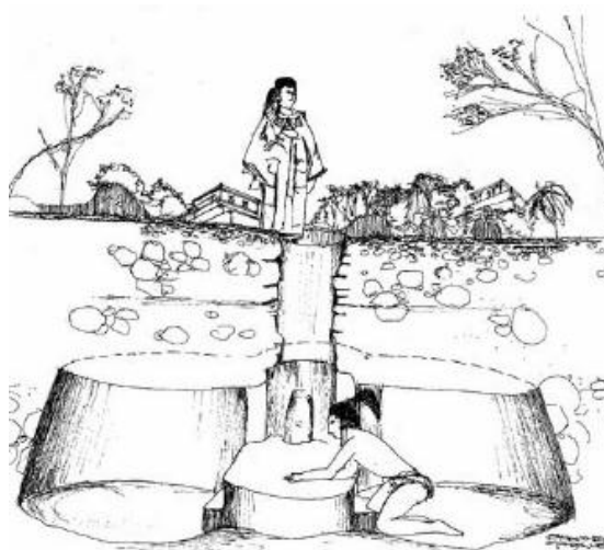
Imagen 2.7 Representación de un chultún y el proceso de impermeabilización interior. Generalmente la impermeabilización se realizaba con argamasa o estuco, las formas eran variadas y fueron considerados vitales para los asentamientos prehispánicos pues se cuentan por miles en la península de Yucatán.
