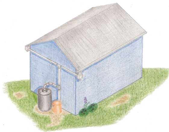
Imagen 5.1 Boceto de una casa con techo a dos aguas implementando el sistema de captación con canaletas y tubos de PVC, filtro de bajante, tanque superficial de ferrocemento con un recipiente para primeras aguas.
