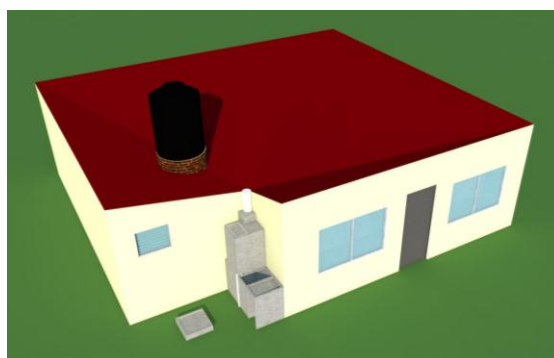
Imagen 5.55 Detalle de la parte posterior de la vivienda donde se muestra el sistema de filtrado.
