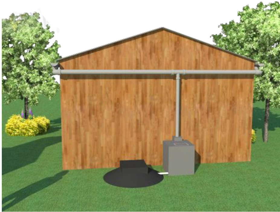
Imagen 5.34 Sistema de tanque enterrado y filtro.
