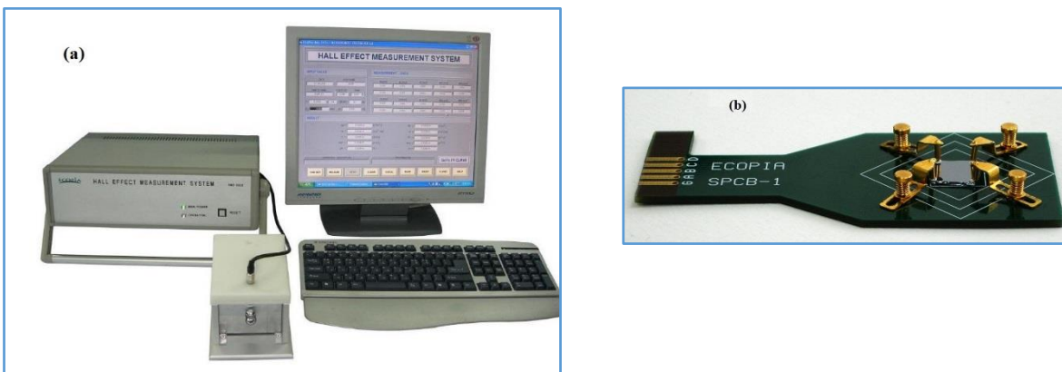
Figura 27. (a) Sistema de Efecto Hall y (b) Porta muestras, empleado en el sistema.
