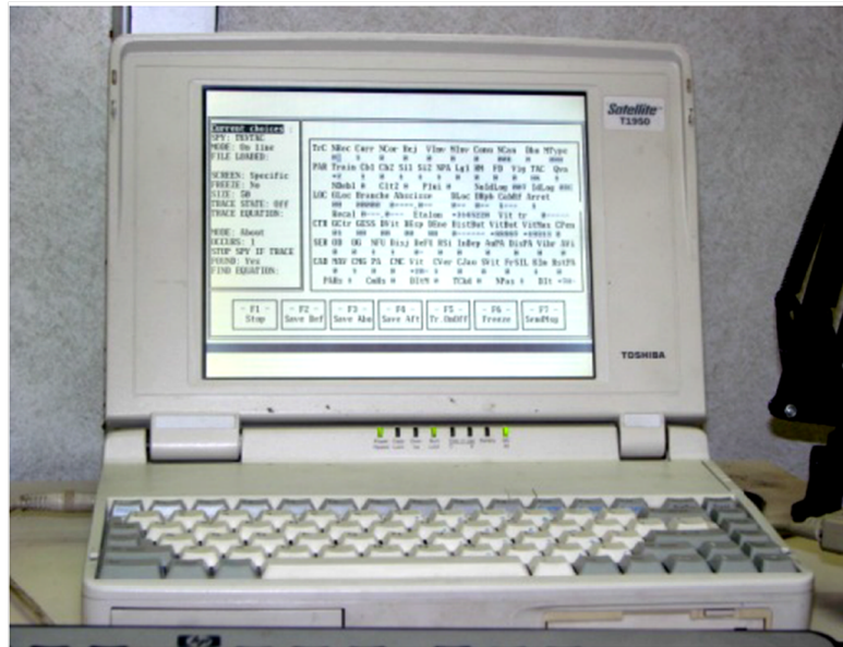
Figura 1.2: Sistema de diagnóstico SPY para el sistema de PA SACEM
