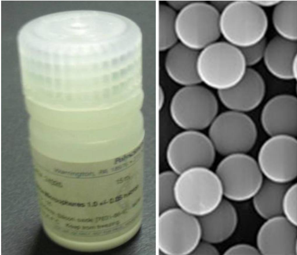
Figura 3.1: En la imagen del lado izquierdo, se muestra una fotografía del frasco contenedor de las micropartículas utilizadas, mientras que la imagen del lado derecho es una imagen ampliada mediante un microscopio electrónico de barrido, ésta última fue tomada de la hoja de datos # 635 de la página electrónica de Polysciences [32].
