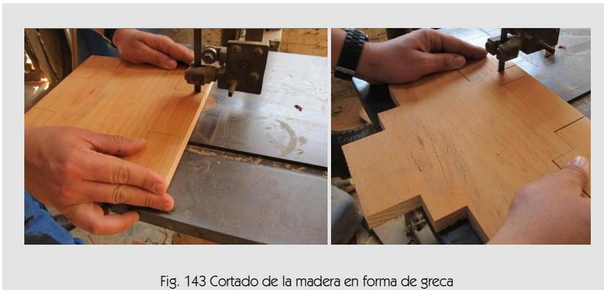
Fig. 143 Cortado de la madera en forma de greca
