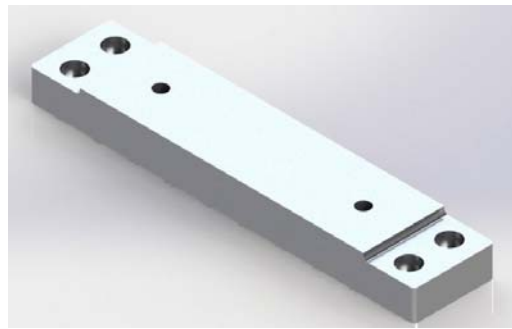
Figura 4.3: Base de motor finalizada.
