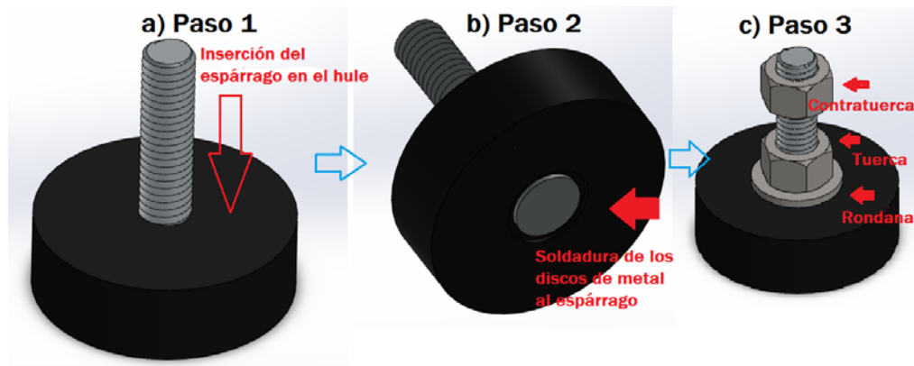
Figura 4.8: Proceso de construcción de las bases niveladoras. a) Inserción del espárrago dentro del hule. b) Soldadura del espárrago con un disco de metal. c) Colocación de la rondana, la tuerca y contratuerca.
