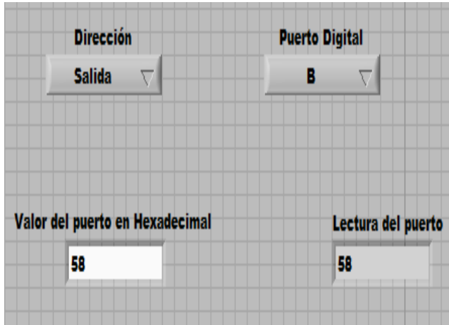
Figura 5.16 Configuración del puerto digital B como salida.
