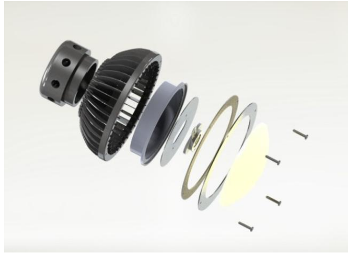
Figura 47. Explosivo del sistema de iluminación.
