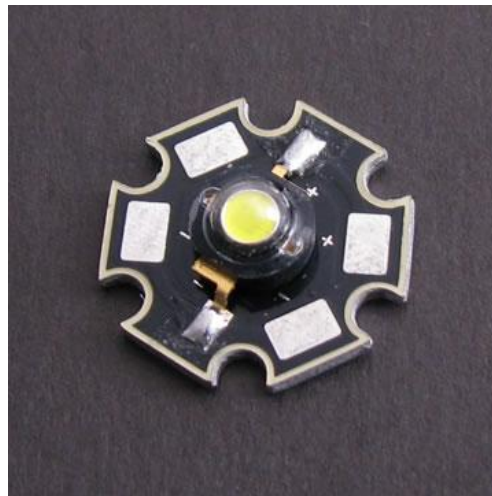
Figura 15. Led de alta potencia.
