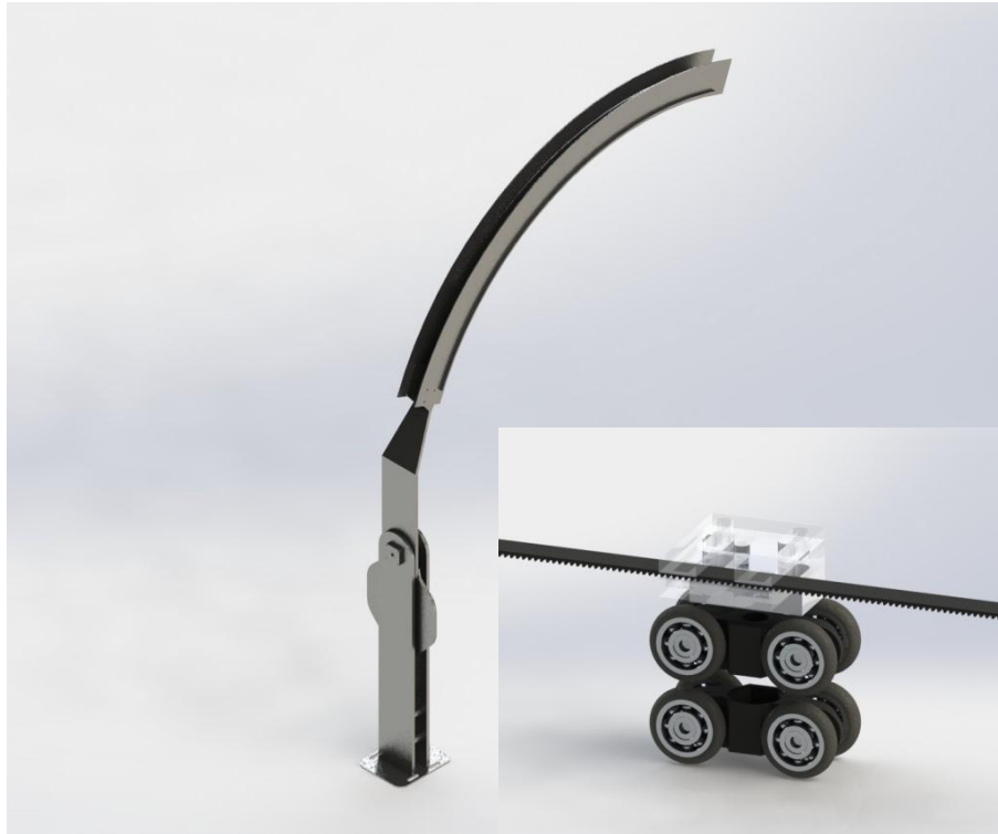
Figura 46. Modelado del concepto seleccionado para la bóveda.
