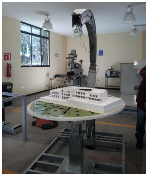
Figura 57. Maqueta sobre el heliodón para evaluación.
