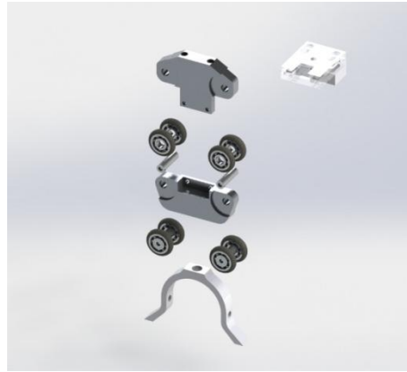
Figura 50. Explosivo del sistema de arrastre.
