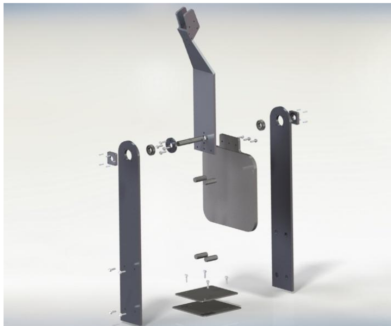
Figura 48. Explosivo del sistema de horas.
