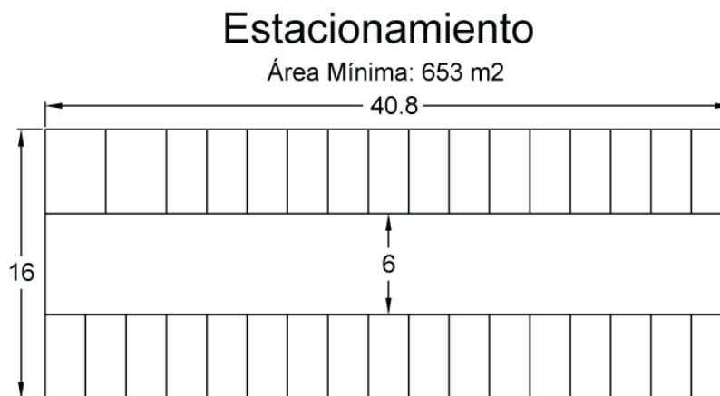
Figura 33 Medidas mínimas de estacionamiento.
