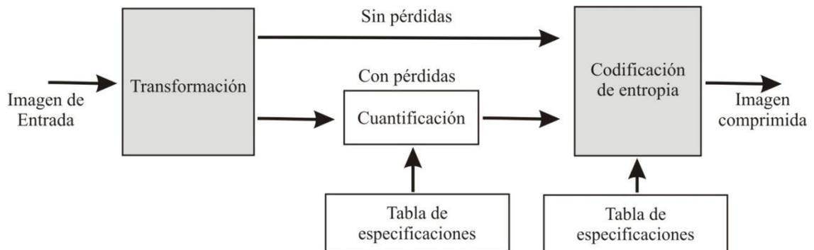
**Figura 2.5.** Elementos de un compresor de imágenes.
