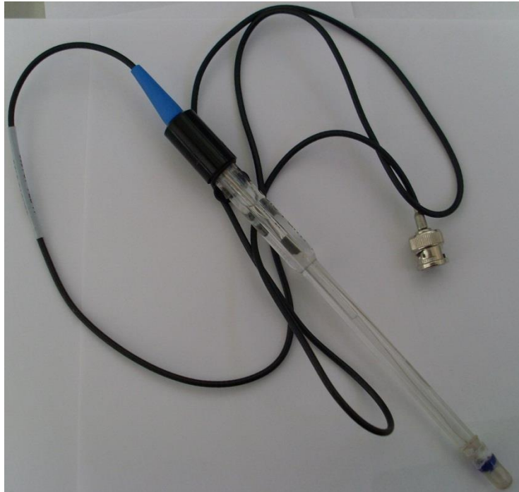
Figura 3.4. Sensor de pH modelo 05991-51.
