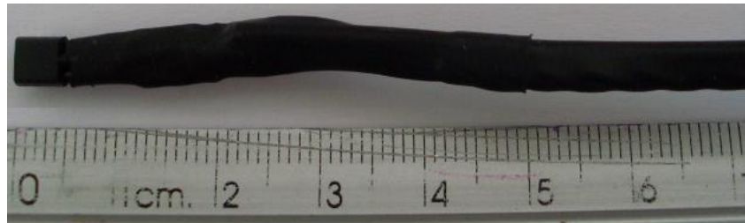
Figura 3.3. Montaje del sensor LM35 en una varilla.
