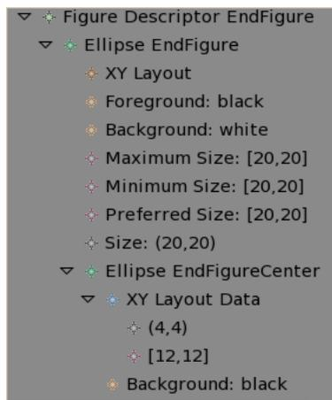
Figura D.4: Estructura del componente *End* después de su configuración.
