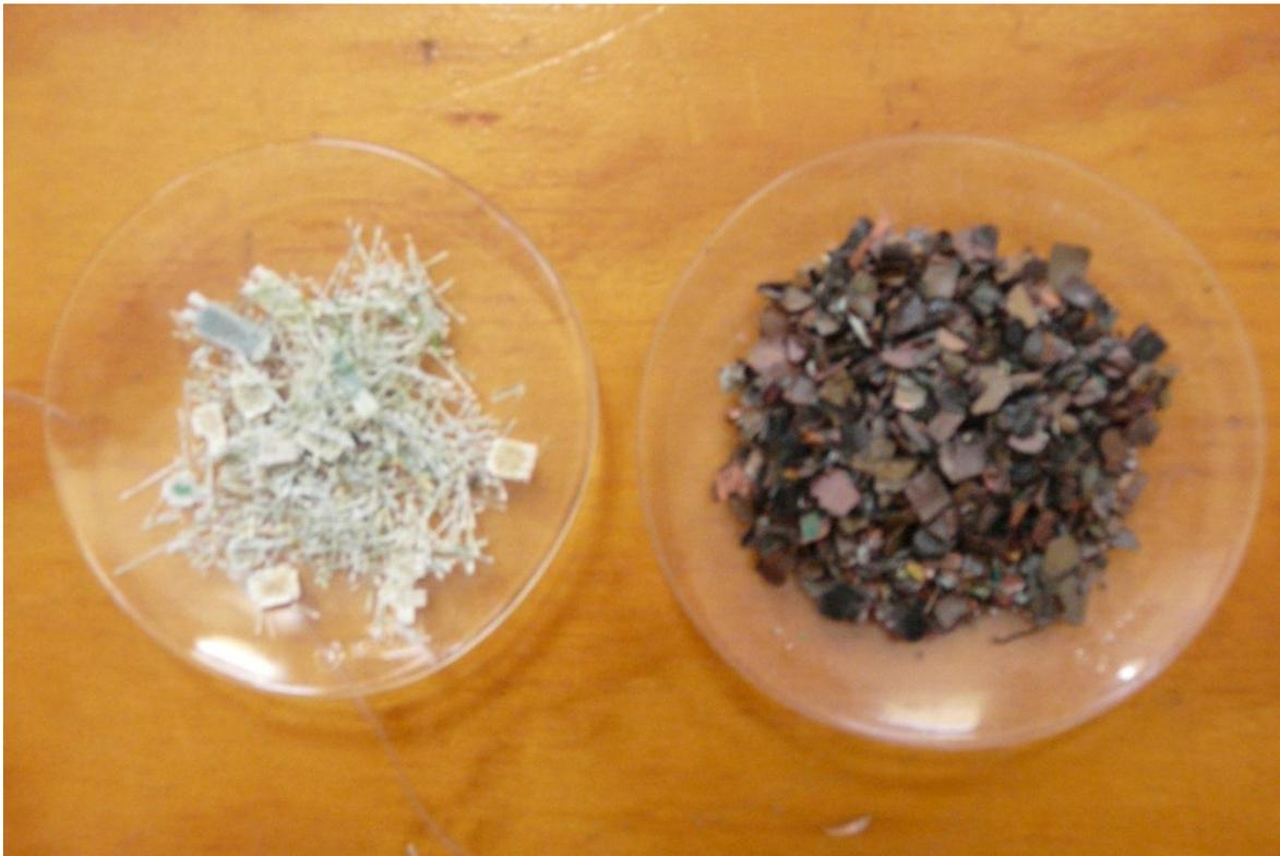
Figura 32.- Fibra de vidrio y metal que conforman la corriente de colas de la prueba 10. (Fuente: Tesista)
