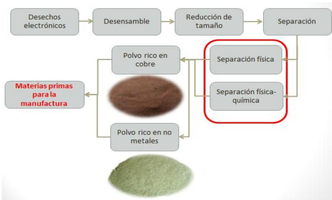
Figura1. Proceso industrial de reciclaje de aparatos eléctricos y electrónicos (DAEE). (Fuente: Tesista)
