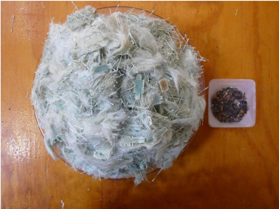
Figura 31.- Fibra de vidrio y metal que conforman la corriente del concentrado de la prueba 10. (Fuente: Tesista)
