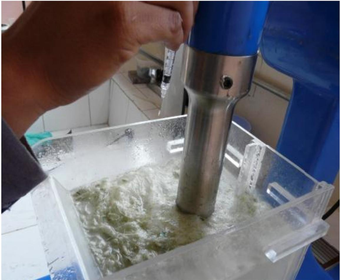
Figura 24. Dosificación de espumante. (Fuente: Tesista)
