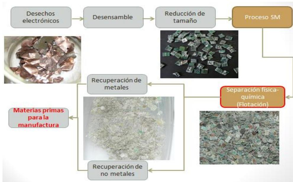
Figura 2. Proceso de reciclaje de PCB que se propone. (Fuente: Tesista)
