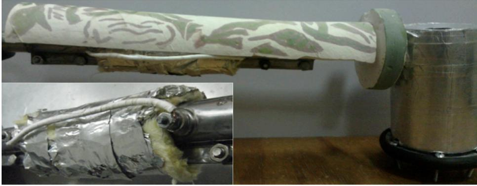
**Figura 32.** Ensamblado de la parte interna del cerámico
