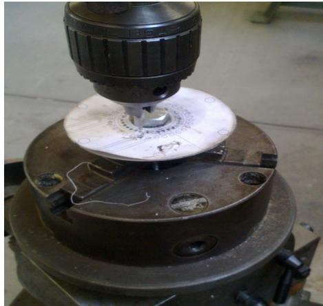
**Figura 25.** Construcción del disco distribuidor
