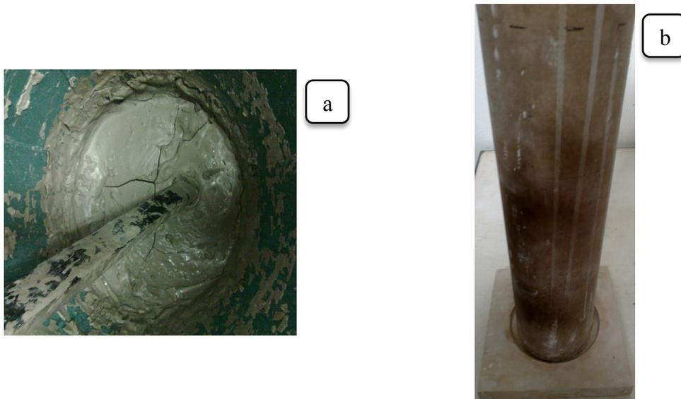
**Figura 28.** Barbotina con exposición al aire (a) y sonotubo anclado a una base de cartón aglomerado (b)
