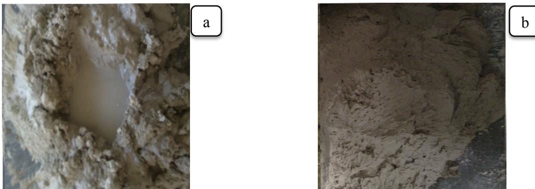
**Figura 26.** Adición de agua a la arcilla (a); incorporación total a la mezcla base (b)
