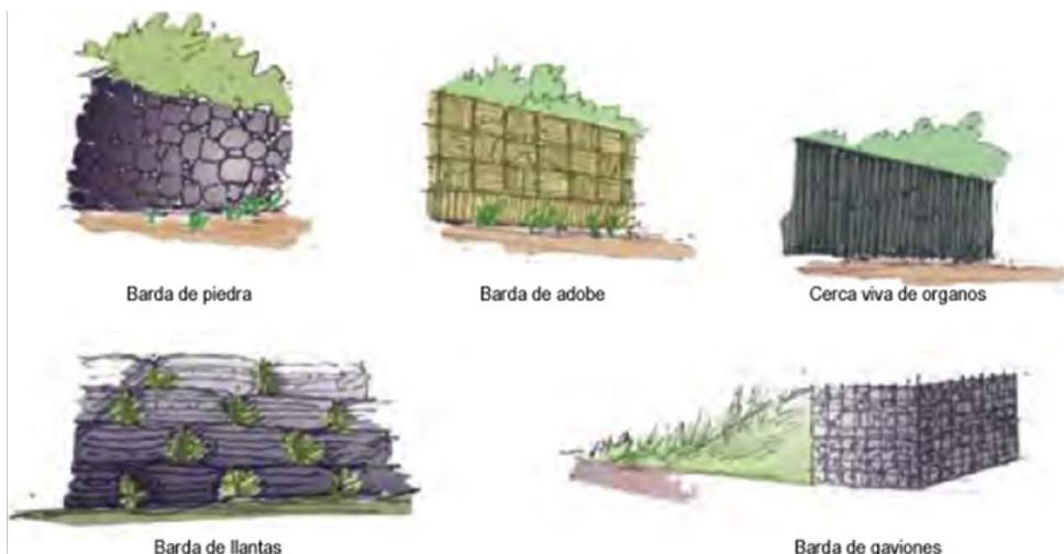
Figura 3. Ejemplos de bardas naturales y de materiales reciclados (llantas y gaviones).
