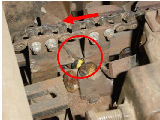
**Figura 1.2** Actuadores de pelado y el desplazamiento relativo del transportador de producto **Fuente:** Fotografías del tesista
