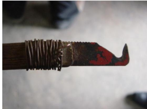
**Figura 1.5** Herramienta manual de pelado de haba seca
