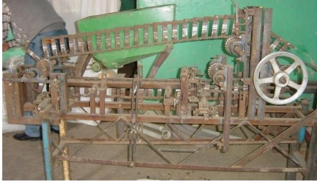
**Figura 1.1.** Prototipo del sistema de pelado Oyameles **Puebla Fuente:** Fotografías del tesista
