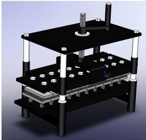
**Figura 3.3** Herramental Mecánico o Sistema Simplificado de Pelado de Habas Secas **Fuente:** Propia
