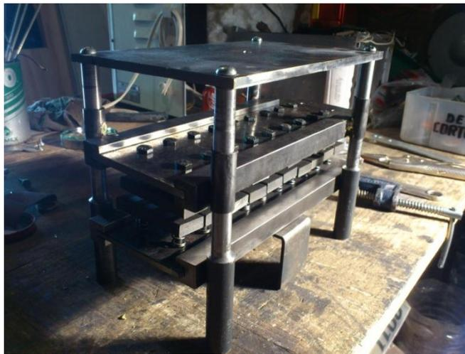
**Figura 4.12** Ensamble previo de los componentes antes de la fijación definitiva y del acabado final. **Fuente:** Propia
