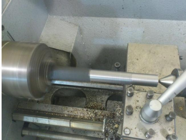
**Figura 4.6** Torneado de componentes del prototipo simplificado. **Fuente:** Propia
