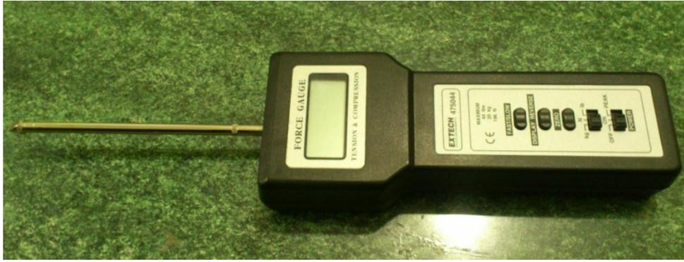
Figura AB4 Medidor digital de fuerza
