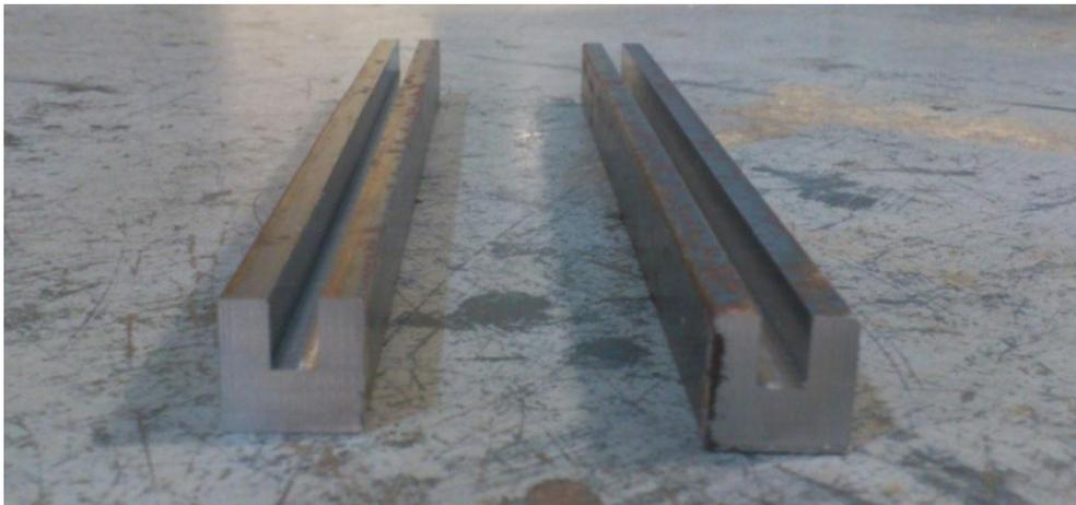
**Figura 4.5** Piezas terminadas después del fresado convencional. **Fuente:** Propia
