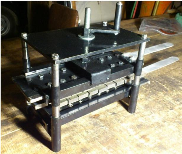
**Figura 4.14** Ensamble terminado del prototipo simplificado del sistema de pelado de haba seca. **Fuente:** Propia
