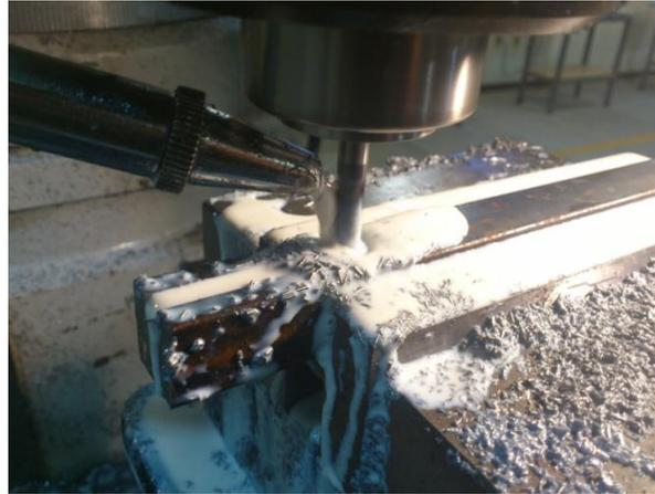
**Figura 4.4** Fresado convencional del riel del prototipo simplificado. **Fuente:** Propia
