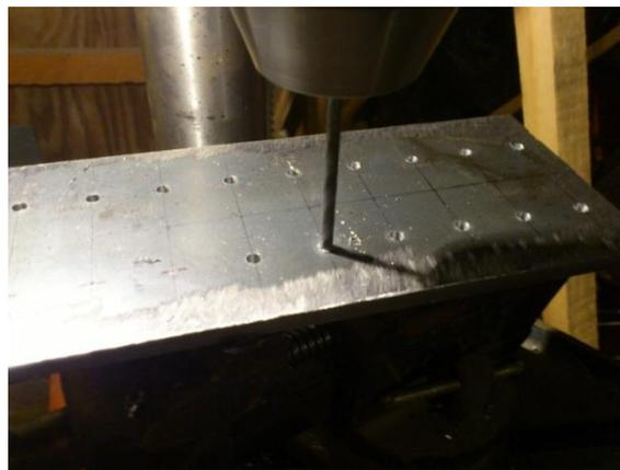
**Figura 4.10** Proceso de taladrado en una placa metálica. **Fuente:** Propia
