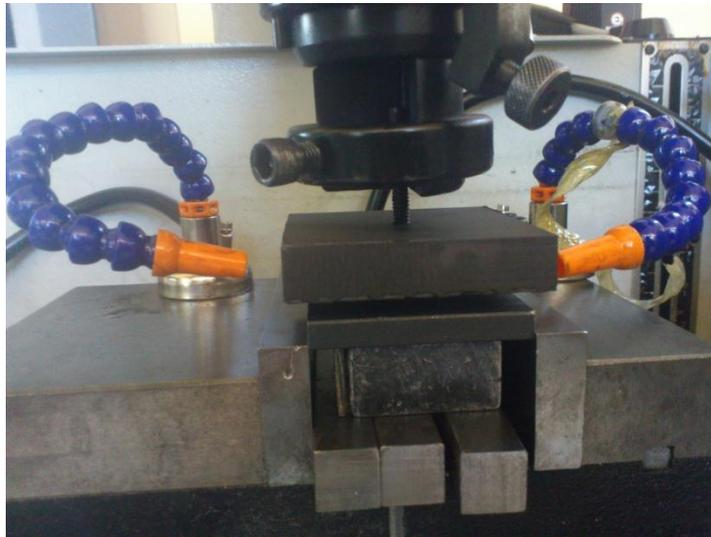
**Figura 4.8** Material y electrodo montados y alineados en la máquina de EDM. **Fuente:** Propia
