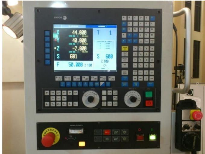
**Figura 4.1** Lectura de código NC por parte de la máquina fresadora CNC **Fuente:** Propia
