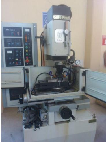
**Figura 4.7** Máquina de electroerosionado perteneciente a la UTM. **Fuente:** Propia
