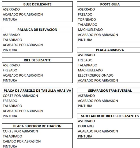
**Figura 3.19** Agrupación de operaciones de manufactura para cada componente del herramental **Fuente:** Propia
