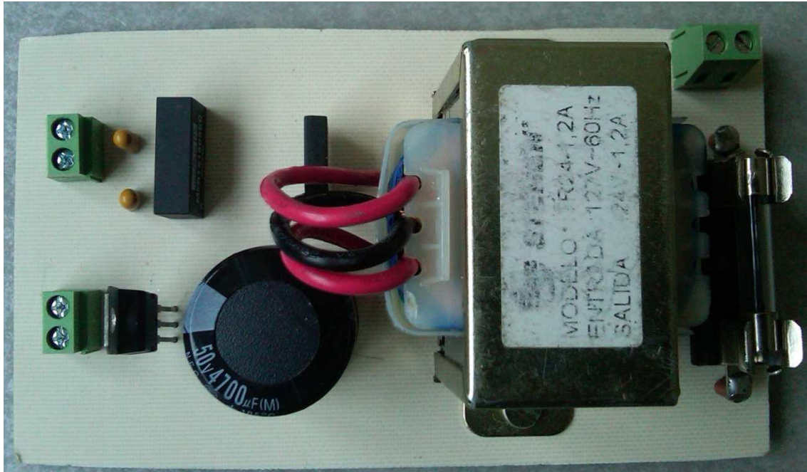
Figura 4.6.1. Construcción del bus de CD de los CI, 5 V y 15 V.
