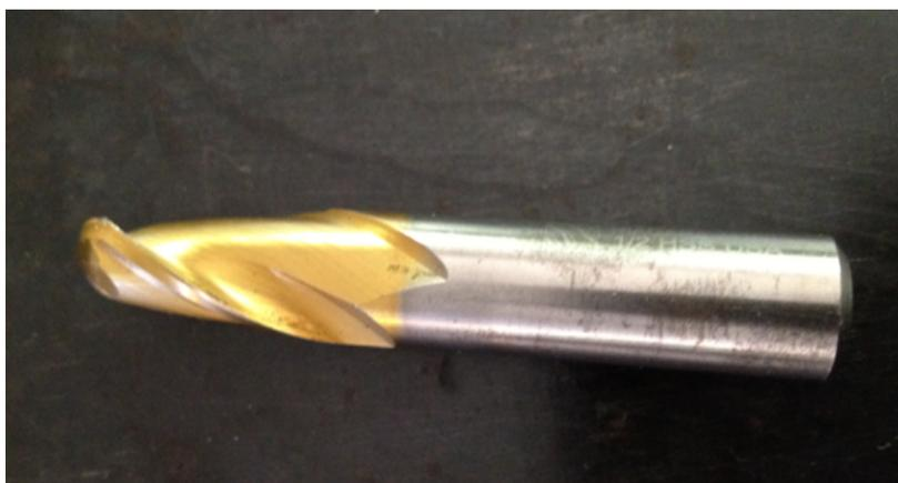
Figura 3.4: Cortador de 1/2 " de bola con 4 gavilanes.
