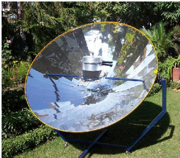
Figura 2.11: Concentrador Parabólico.
