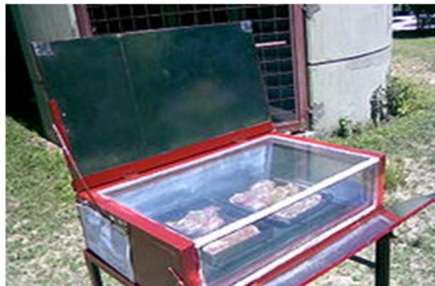
Figura 2.7: Horno Tipo Caja Modelo Steves.
