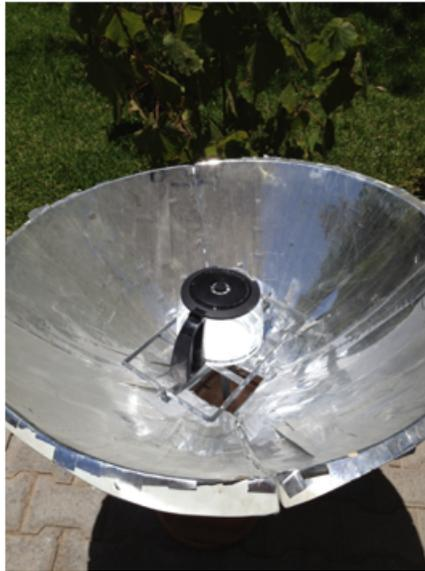
Figura 4.26: Calentamiento de agua en una jarra de vidrio en un concentrador solar.
