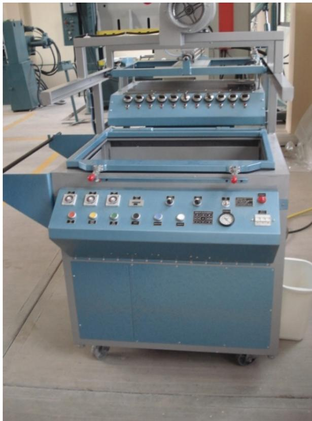
Figura 3.5: Termoformadora.
