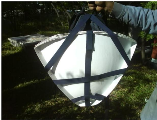
Figura 4.22: Red de transporte para el Concentrador Solar.
