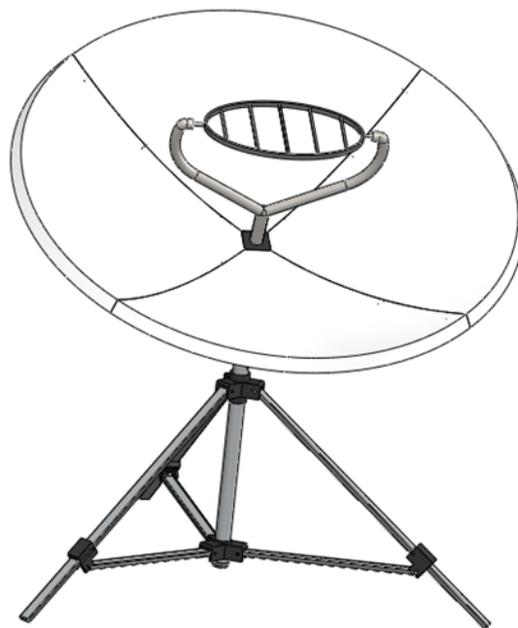
Figura 4.21: Concentrador Solar Armado.
