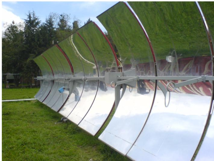
Figura 2.10: Concentrador Cilíndrico.
