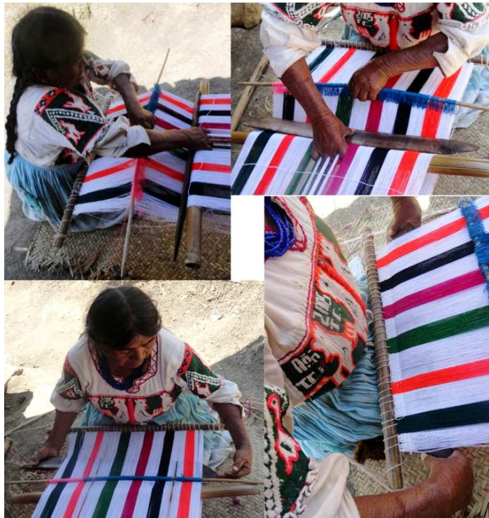
Figura121. Cambio de posición de los hilos y uso del machete para apretar el tejido.
