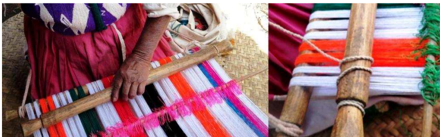
Figura115. Las madejas de hilos se amarra al enjulo superior en forma de espiral.
