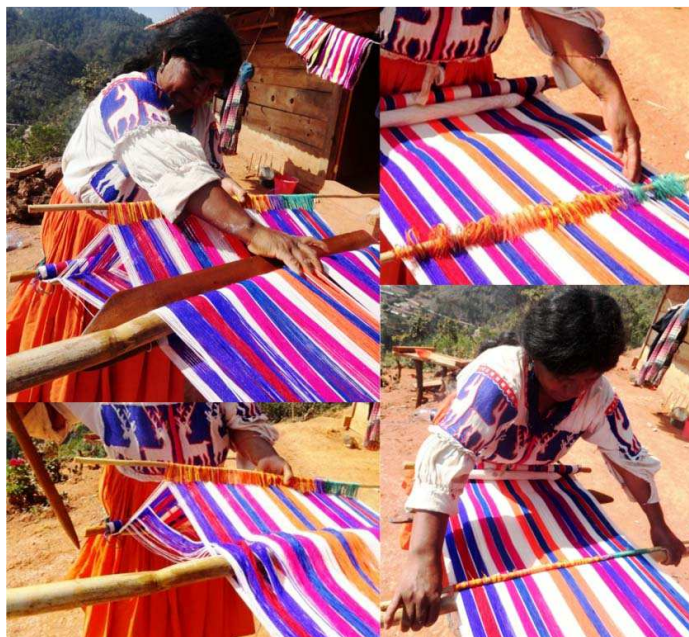
Figura122. Durante el crecimiento del tejido la tejedora separa los hilos con sus dedos y va enrollando el tejido en el enjulio.
