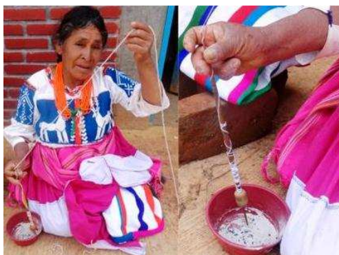
Figura 94. El malacate y la manera de hilar. El uso del malacate facilito la velocidad al hilar.
