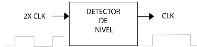
Figura 2.4. Diagrama a bloques de la descripción funcional del componente Divisor de Frecuencia.
