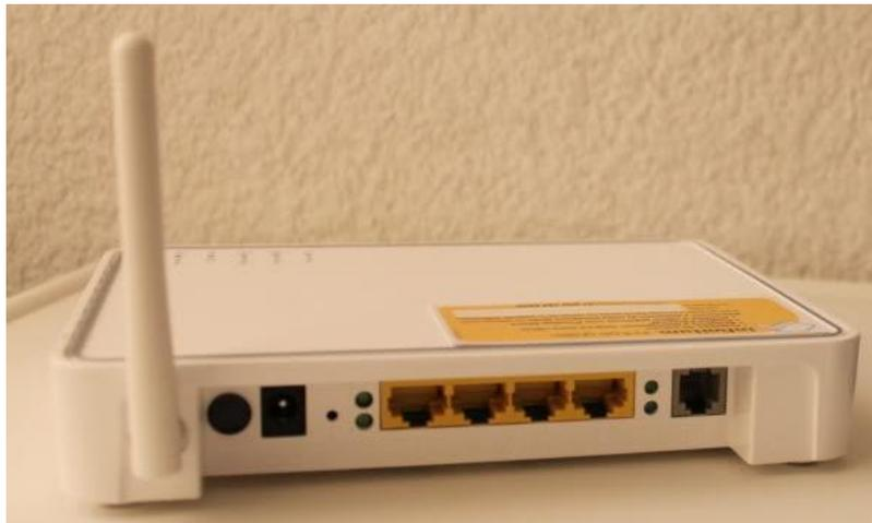
**Figura 1.** Modem router Thomson Gateway con AP integrado.
