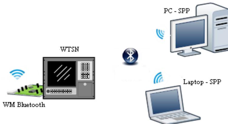
**Figura 3.** Envío de temperatura a dos servicios SPP.
