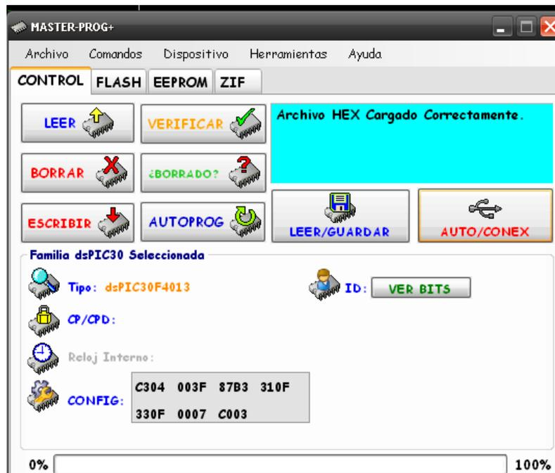
Figura 5.91. Interfaz del programador MASTER-PROG.
