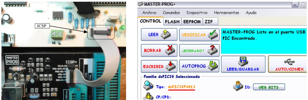
a) Conexión del puerto ICSP de la Plataforma Iron al programador MASTER-PROG
