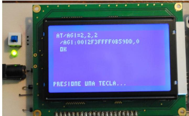
**Figura 5.106.** Búsqueda de dispositivos ZigBee.
