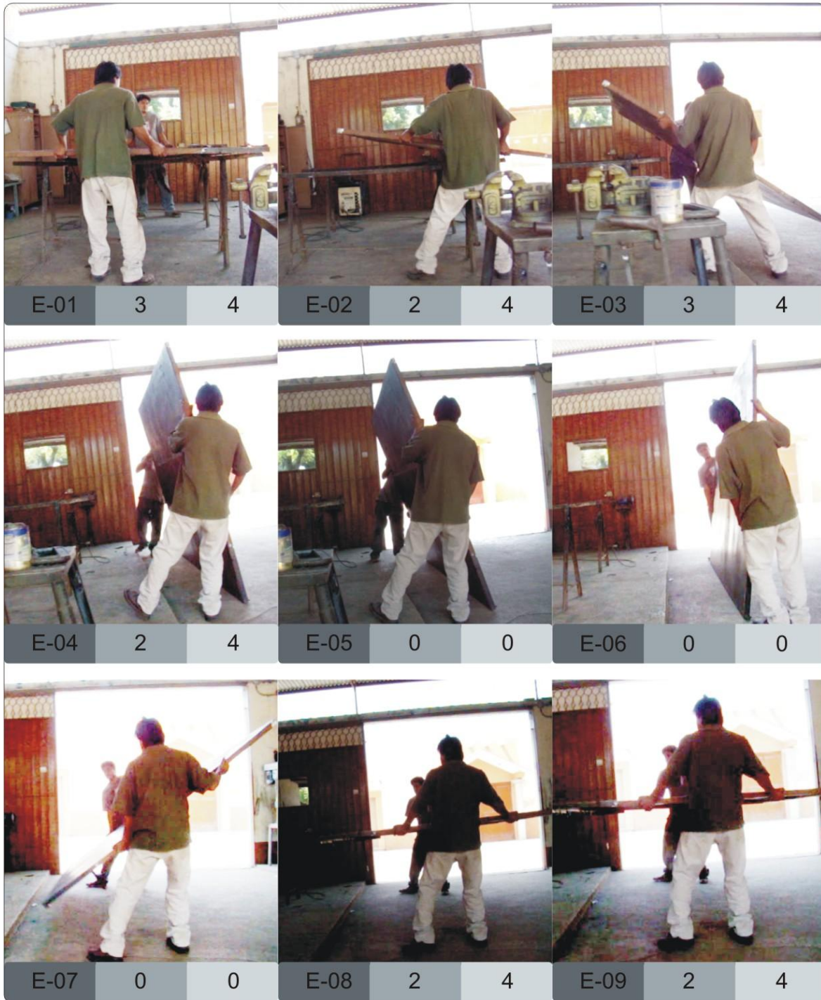
Figura 76. Secuencia de movimientos en vista lateral para el giro de una estructura efectuada por el trabajador C.
