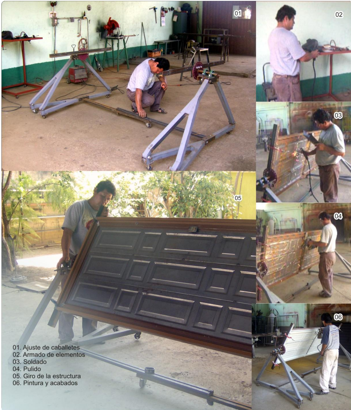
FIGURA 50. Desarrollo de la fase de armado/soldado utilizando los Cabaltes A.
