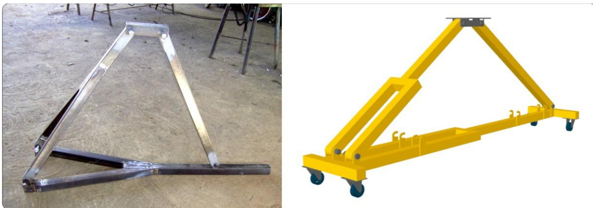
FIGURA 57. Rediseño de la Estructura Principal de Carga
