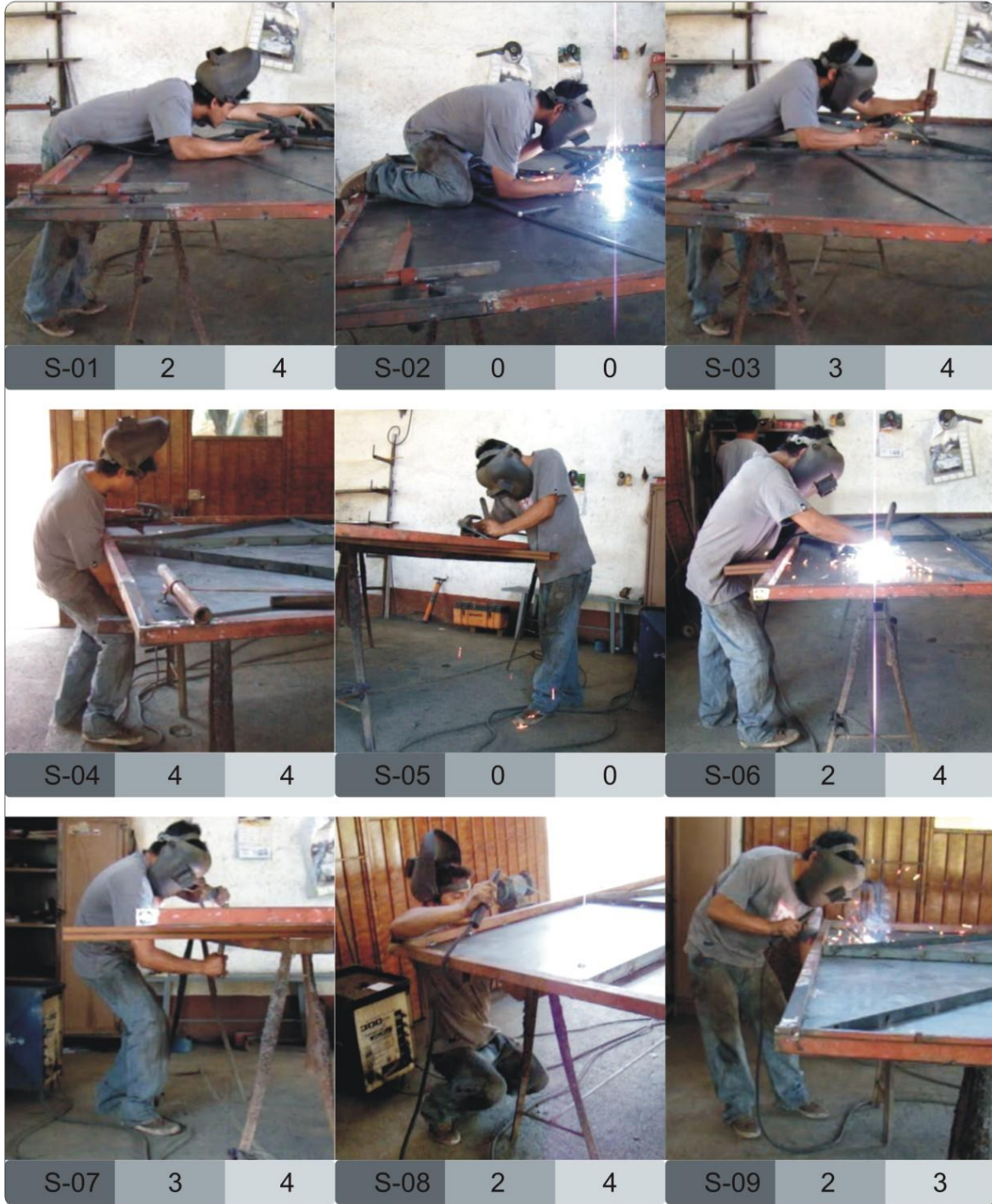
FIGURA 68. Posturas de trabajo identificadas en el desarrollo de la sub-fase de soldado
