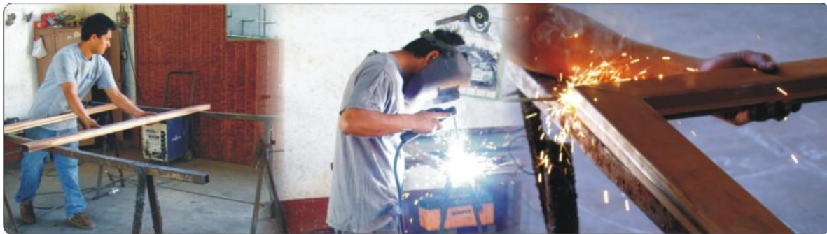
FIGURA 15. Uso de caballetes en el taller para el armado de piezas
