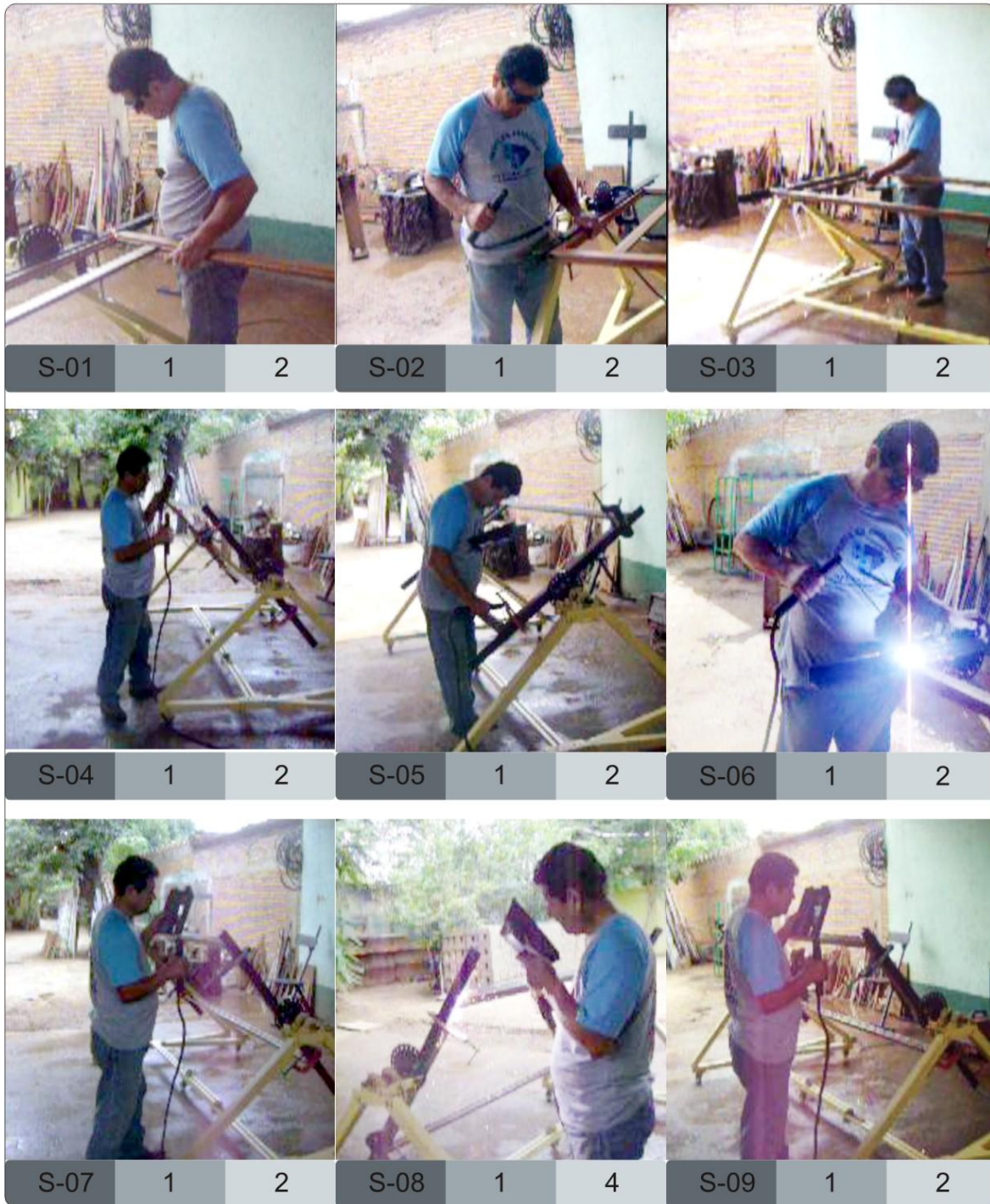
Figura 80. Posturas de trabajo identificadas en el desarrollo de la sub-fase de soldado
