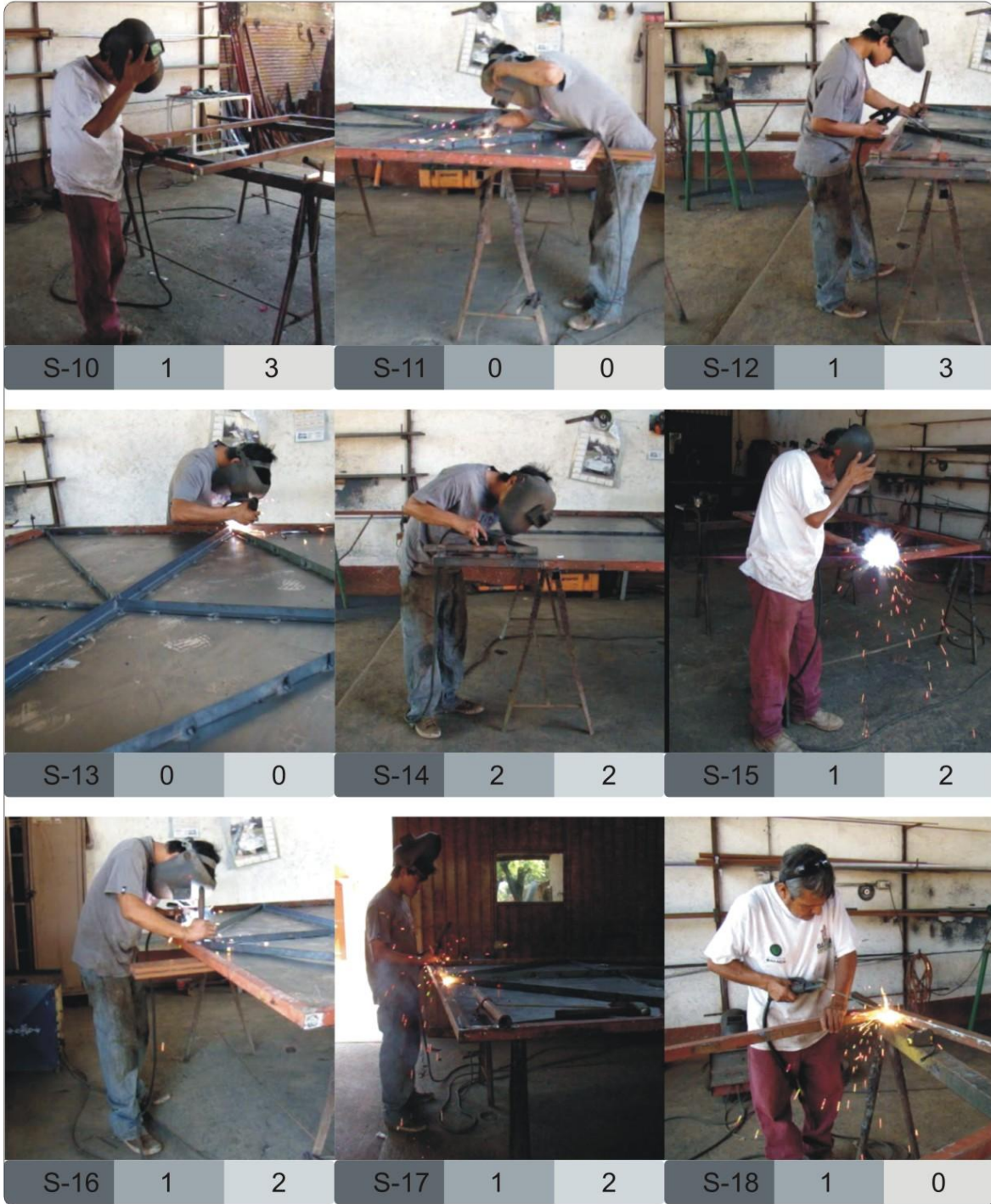
FIGURA 69. Posturas de trabajo identificadas en el desarrollo de la sub-fase de soldado
