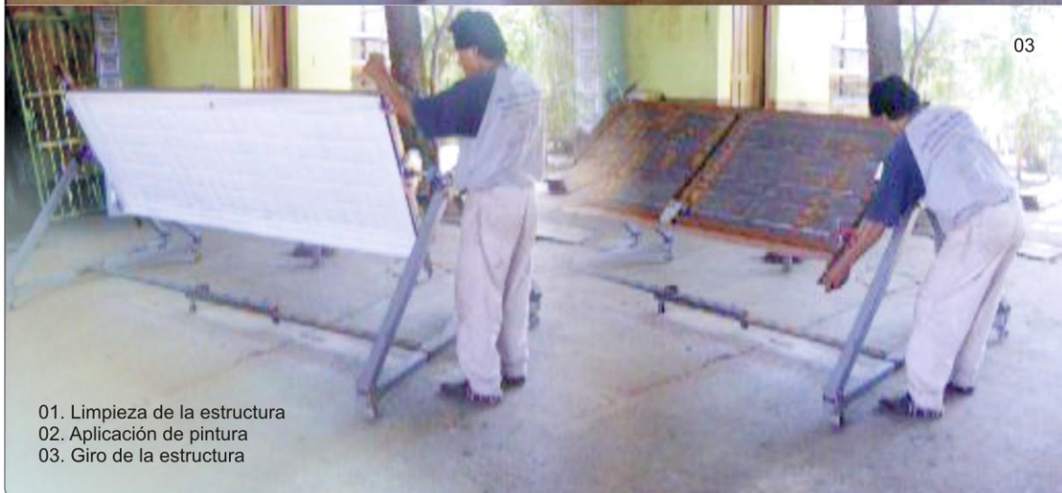
FIGURA 51. Desarrollo de la Sub-fase de Pintura y acabados utilizando los Caballetes A.
