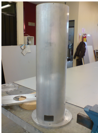
Figura 3.7: Barreno en la parte inferior del tubo
