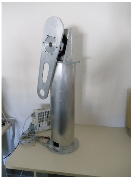
Figura 3.10: Robot de transmisión directa de un GDL
