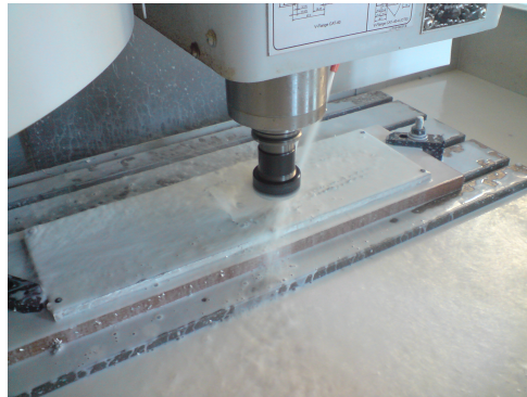
Figura 3.4: Proceso de manufactura del eslabón
