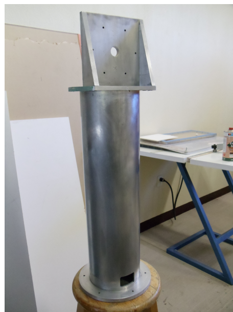
Figura 3.9: Ensamble del soporte del robot
