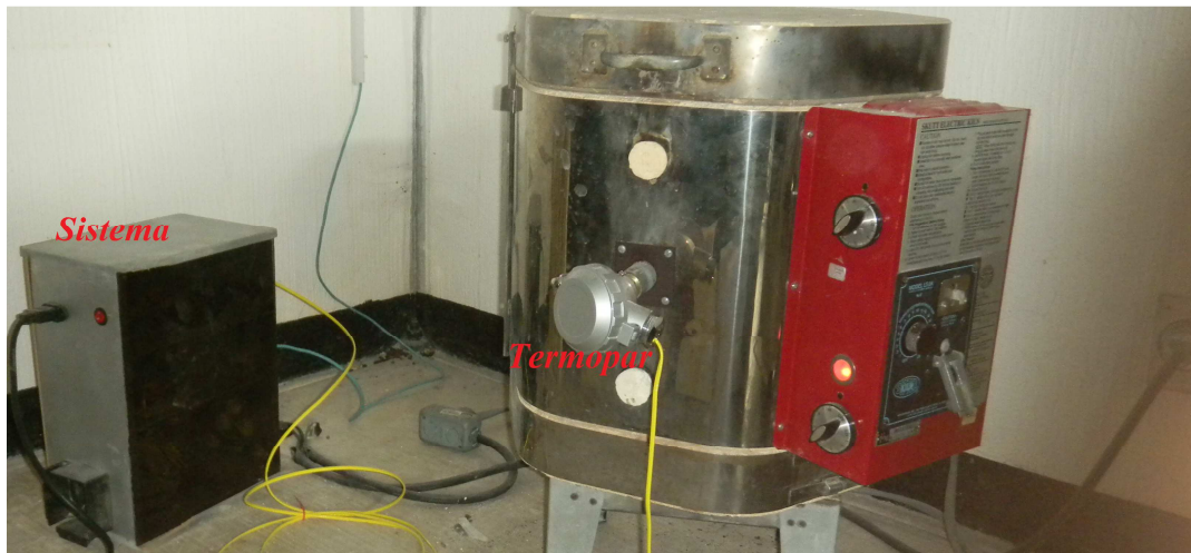
Figura 4.1. Sistema de control difuso en operación.
