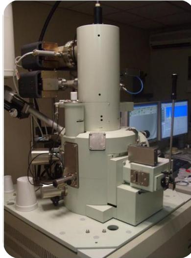
**Figura 3.2** Microscopio electrónico de barrido JEOL JSM-7401F
