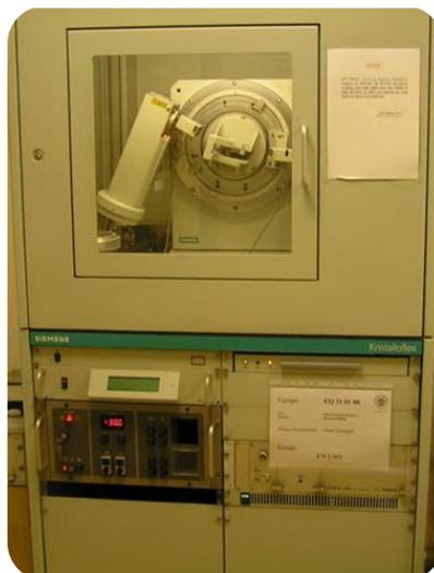
Figura 3.4 Difractómetro SIEMENS D5000
