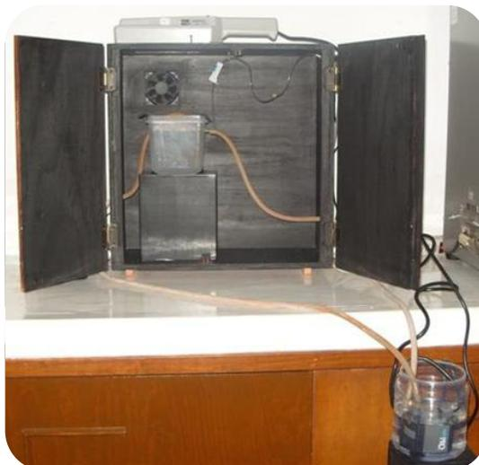
**Figura 3.9 Sistema utilizado en las pruebas de fotocatalisis de la solución de AMet**
