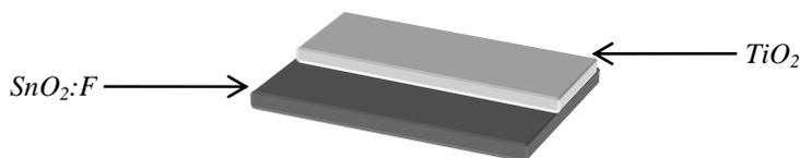
Figura 4.38 Arreglo 2, capa de  $SnO_2:F$  con la mitad cubierta con una capa de  $TiO_2$
