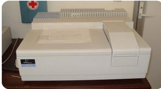
Figura 3.6 Espectrofotómetro UV-Vis Lambda 35 UV/VIS de Perkin Elmer Instruments
