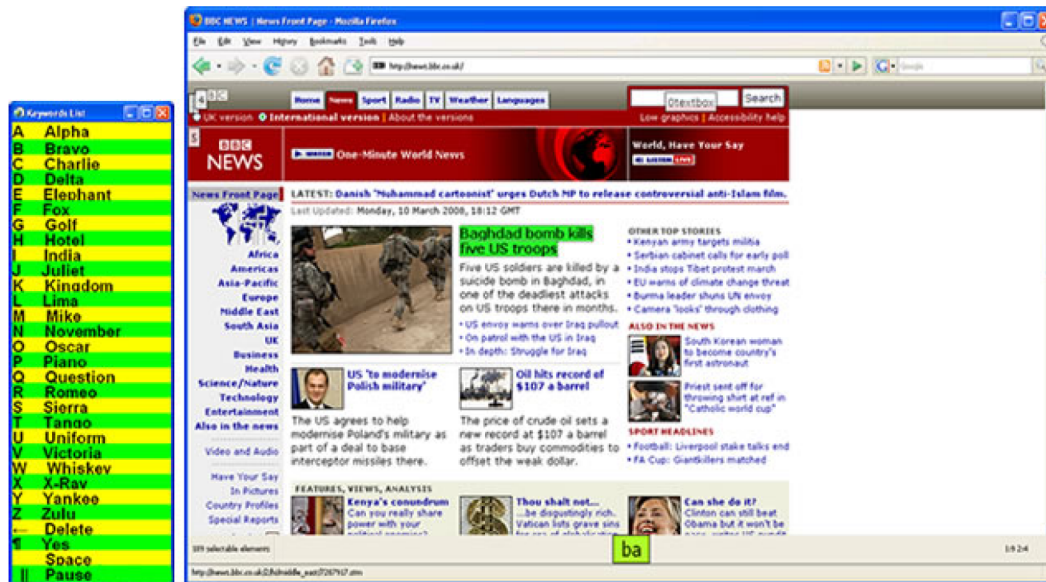
Figura 3.4: Interfaz WebSpeak integrada con CanSpeak (lista de palabras del lado izquierdo), y KeySurf integrado con un navegador de Internet (lado derecho)
