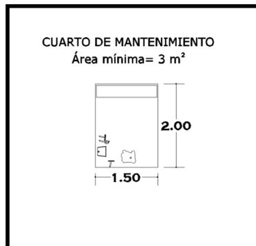
**Diagrama32:** Análisis del área mínima requerida para el cuarto de mantenimiento.
