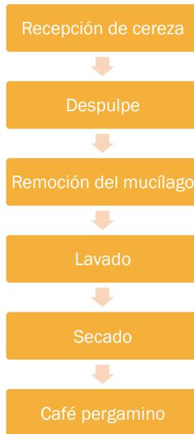
**Diagrama2:** Diagrama de flujo del método húmedo
