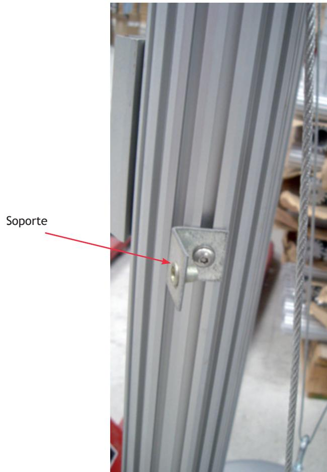
Fig. 82. Soporte para tolva metálica
