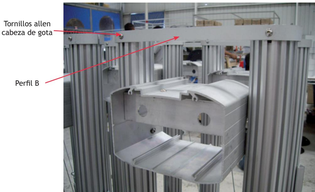
Fig. 77. Ensamble de Perfil B
