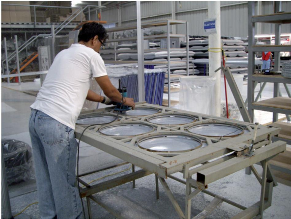
Fig. 52. Corte de cubiertas plásticas
