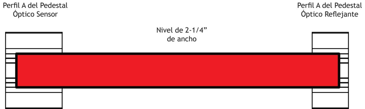
Fig. 80. Vista superior de nivel y canal en el perfil A para alineamiento horizontal
