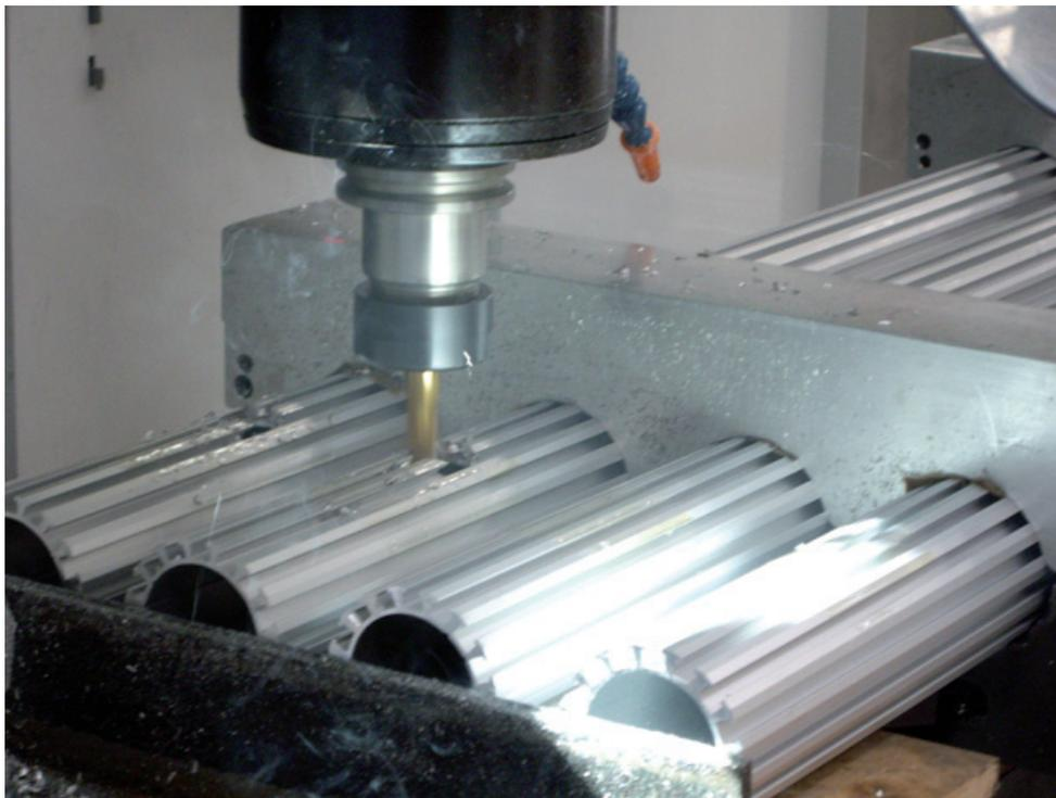
Fig. 60. Fresado de perfiles corona para paso de cables
