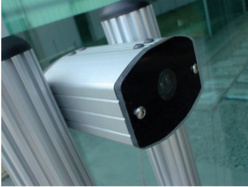
Fig. 29. Prototipo de pedestal óptico sensor (Propuesta 3)
