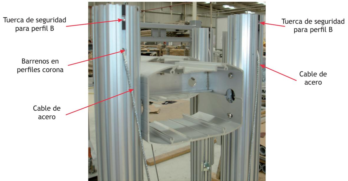
Fig. 75. Cable de acero en perfil corona
