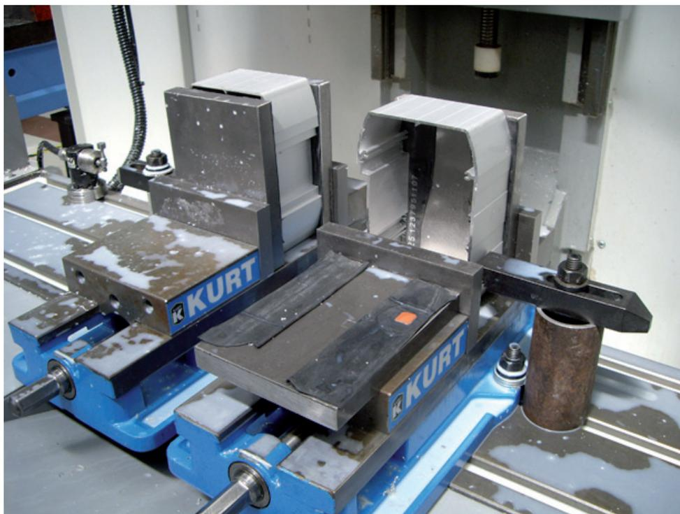
Fig. 65. Barrenado de perfil A para sistema de ajuste
