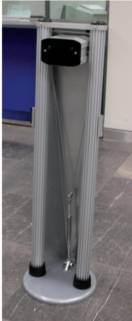
Fig. 31. Prototipo de pedestal óptico sensor (Propuesta 5)
