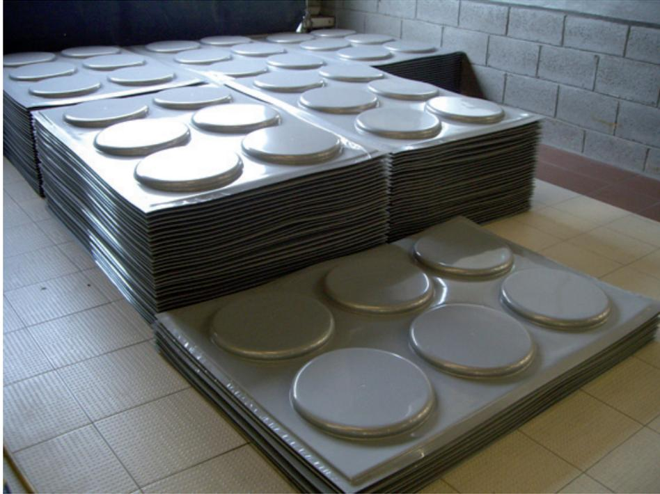
Fig. 51. Cubierta plástica termoformada en juegos de seis piezas
