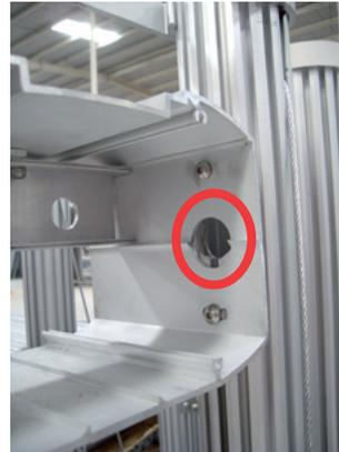
Barreno para paso de cables de Perfil A a perfil corona
