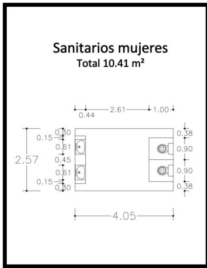
Diagrama 20. Medidas mínimas de los sanitarios de trabajadores para mujeres
