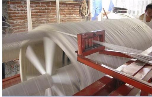
Figura 14. Paso de hilos por peine y enrollado.
