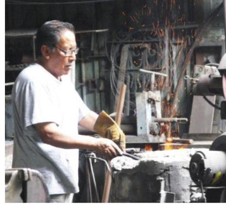
Figura 35. Forjado en fragua.
