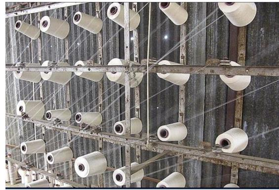
Figura 12. Posición de hilos en fileta.
