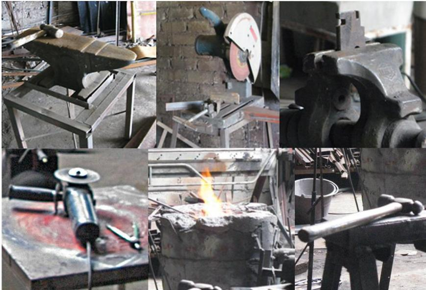
Figura 31. Herramientas de metalistería. Arriba, de izquierda a derecha: yunque y mazo, cortadora eléctrica de disco, grifa. Abajo, de izquierda a derecha: amoladora, fragua, martillo.
