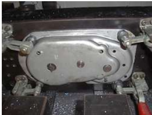
Fig. 38 Dispositivo Funcional para Localizar barrenos
