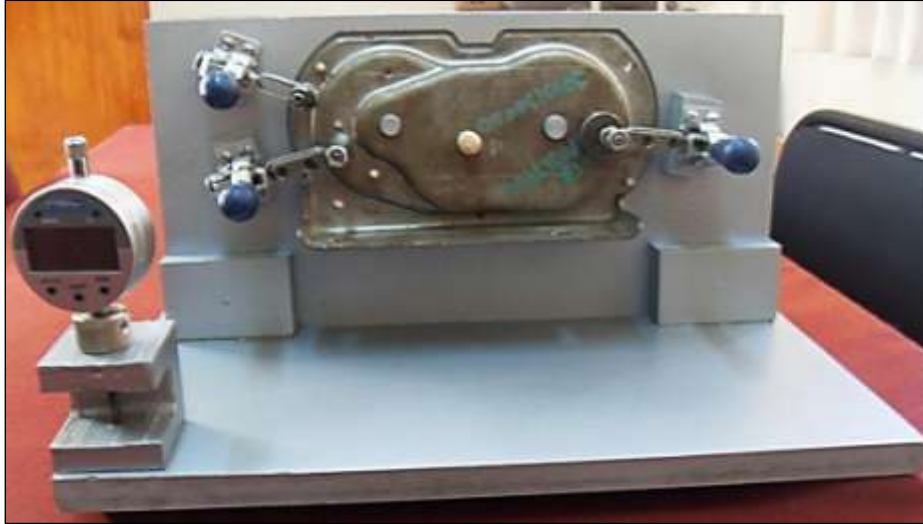
Fig. 71 Inspección de la pieza en el Prototipo Fuente Propia
