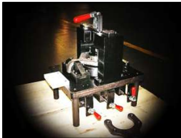
Fig. 1 Calibrador Funcional Pasa/No Pasa
