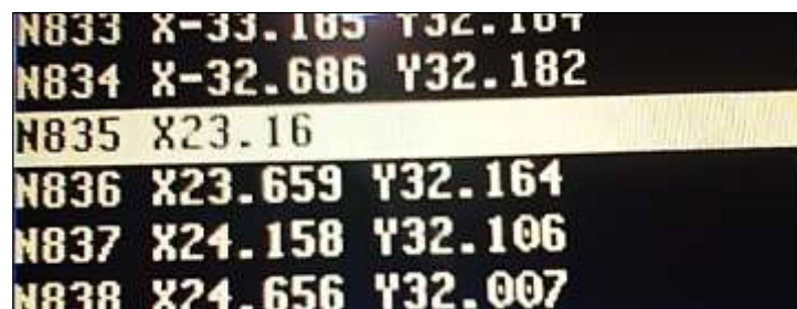
Fig. 62 Códigos numéricos y Simulación del maquinado
