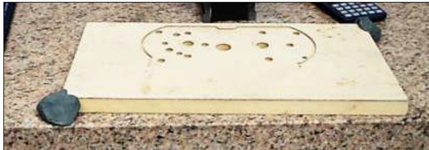
Fig. 64 Sujeción en mesa de Mármol
