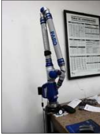
Fig. 40 Máquina de Medición por Coordenadas Fuente Propia
