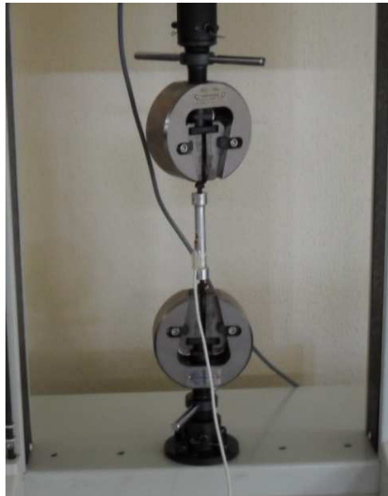
Figura 4.5. Galga fijada en la máquina de tensión
