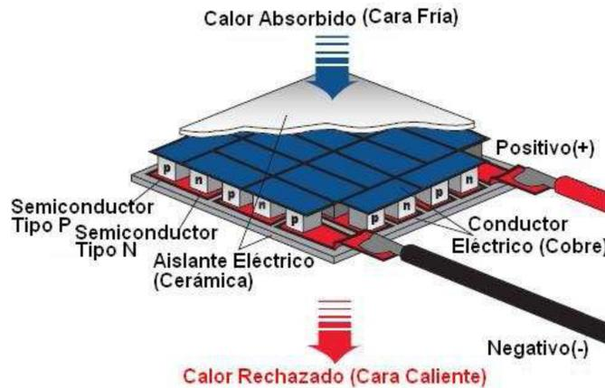
Figura 2.2: Diagrama de un módulo termoelectrico. Tomada de [48]
