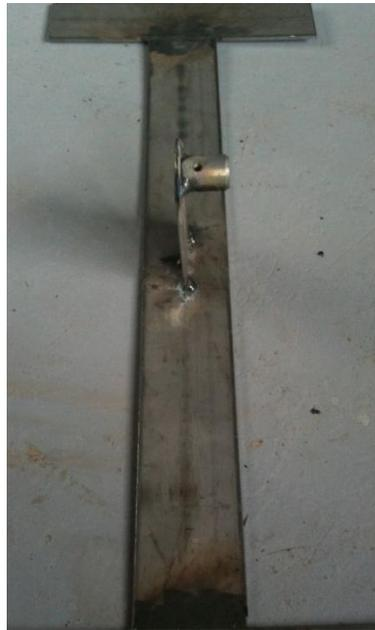
**Figura 3.19 Cople soldado a uno de los soportes del panel fotovoltaico.**
