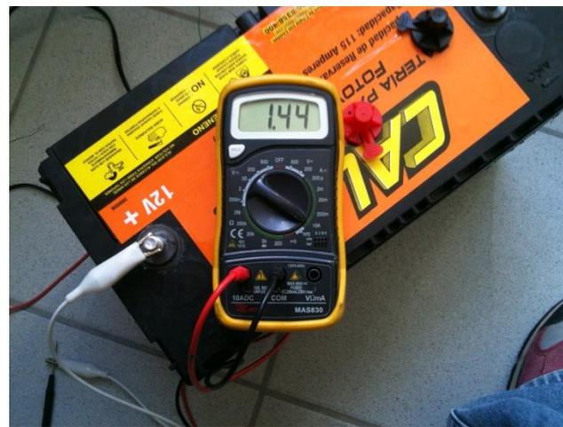
**Figura 4.13** Corriente a la salida del controlador de carga.
