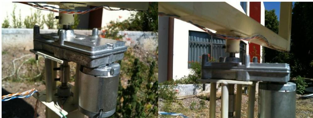
**Figura 3.26 Ensamble del motor con la base y el balancín.**
