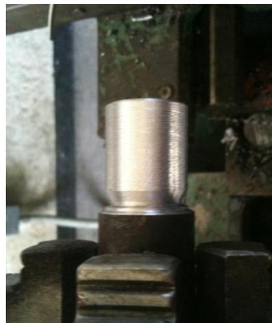
**Figura 3.15** Fabricación del cople en el torno.
