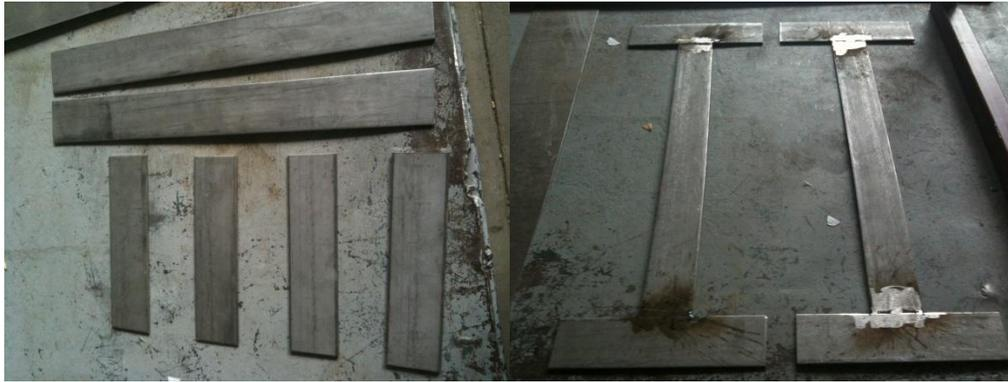
**Figura 3.10** Fabricación y ensamble del soporte para el panel fotovoltaico.
