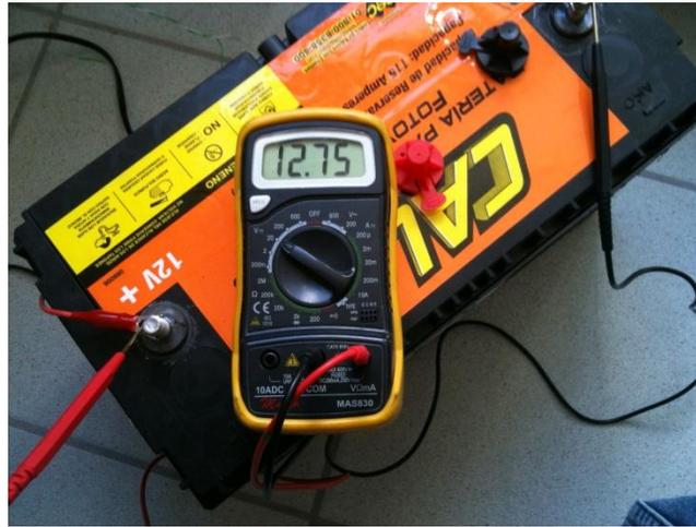
**Figura 4.12** Voltaje a la salida del controlador de carga.
