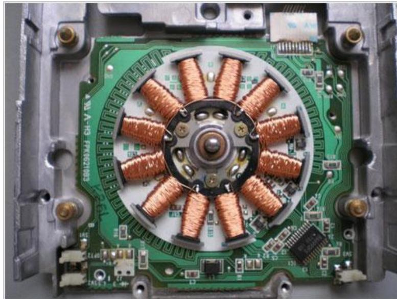
Figura 2.9 Motor de una unidad de discos flexibles.
