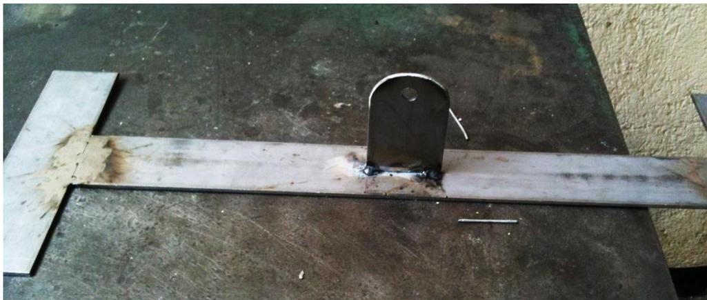
**Figura 3.18 Piezas soldadas al soporte para el panel fotovoltaico.**
