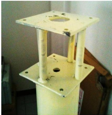
**Figura 3.24 Soporte para el motor (Angulo Azimut).**
