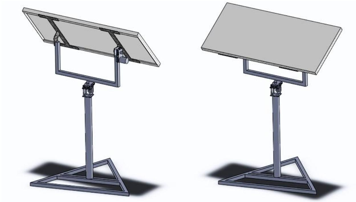
**Figura 3.4 Ensamble final del SSFA en Solidworks**
