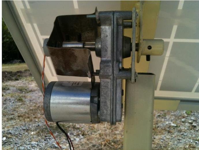
**Figura 3.27** Ensamble del motor al balancín.
