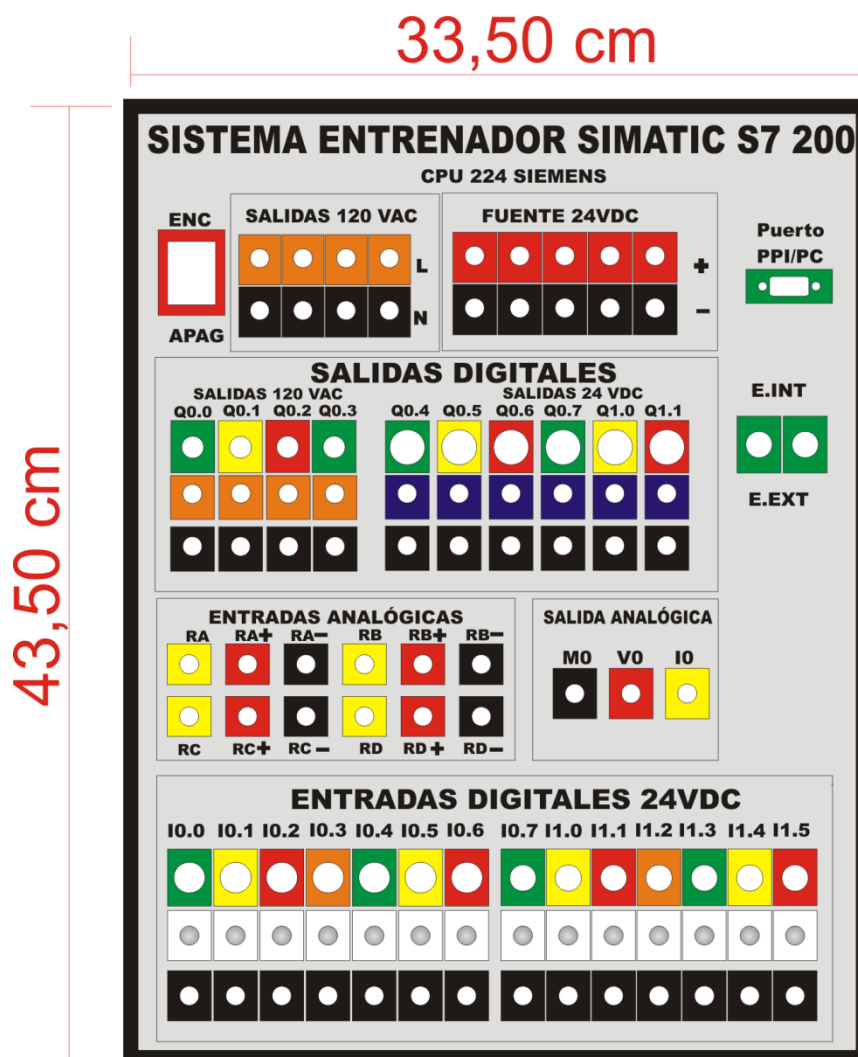
Figura 3. 8 Etiquetas realizadas en vinil del SAE-PLC realizado en Corel Draw X3.
