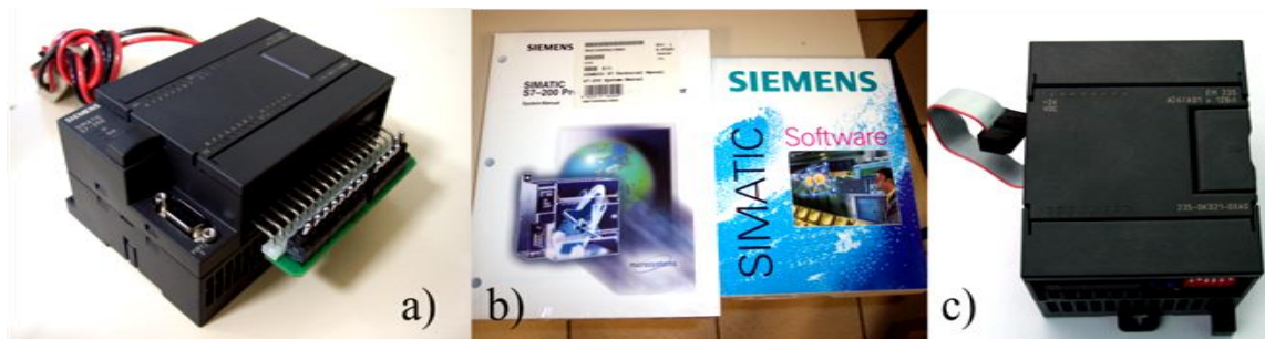
Figura 3. 3 PLC de la familia S7-200 del fabricante Siemens que posee en su inventario la Universidad Tecnológica de la Mixteca a) CPU 224, b) programa MicroWin STEP 7 para programar el PLC, c) módulo de expansión EM 235 de entradas y salida analógica.
