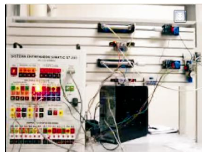
Figura 4. 6 Práctica 6, activación de electroválvula doble cilindro
