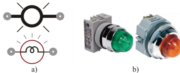
Figura 2.13 Lámparas indicadoras a) símbolo, b) lámparas piloto industriales IDEC [18].
