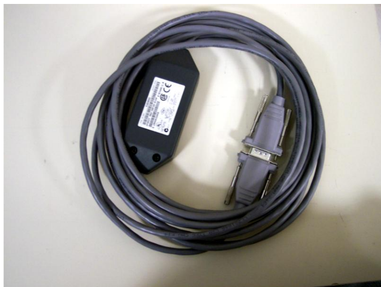
Figura P1. 3 Cable PC/PPI para establecer la comunicación entre el sistema SAE-PLC y la PC.
