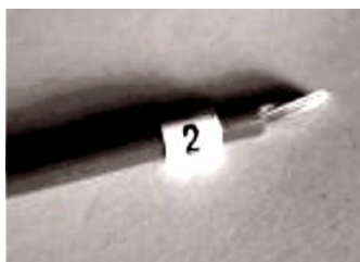
Figura 2.18 Ejemplo de etiqueta de un cable.
