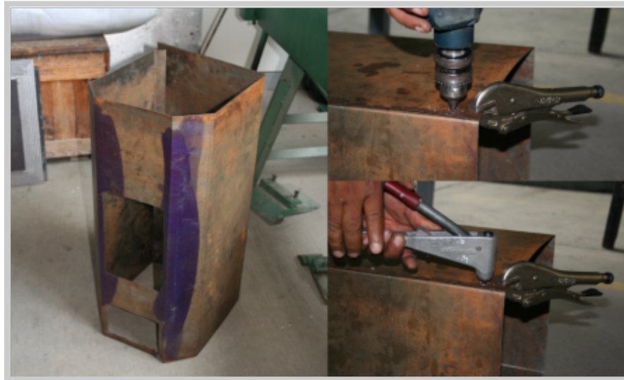
Fig. 5.4 Ensamble de los extremos de la carcasa principal.
