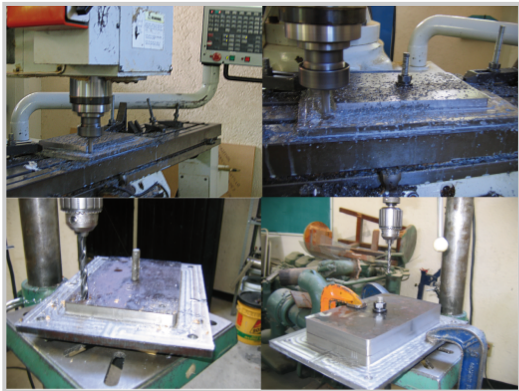
Fig. 5.1 Maquinado y preparación de los moldes.
