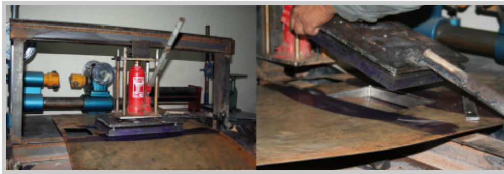
Fig. 5.2 Perforado de cuerpo y compartimiento para termostato.
