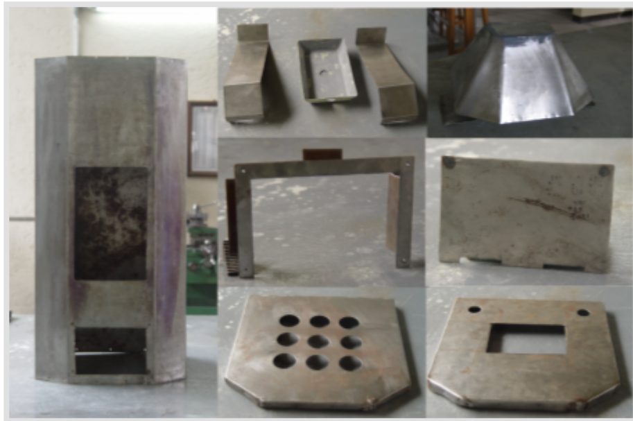
Fig. 5.7 Habilitado de las piezas para aplicar acabados superficiales.
