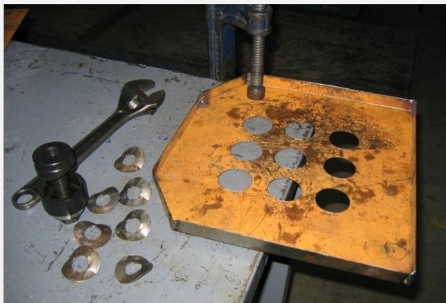
Fig. 4.23 Perforado con sacabocados.
