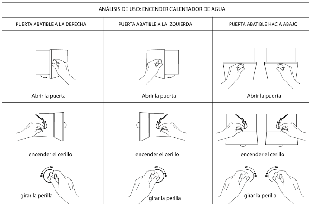
Fig. 2.3 Posibles direcciones de abatimiento para la puerta de la cámara de combustión.
