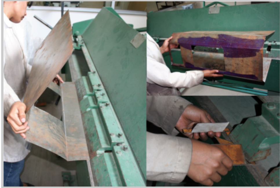
Fig. 5.3 Doblado de lámina, del cuerpo principal de la carcasa.
