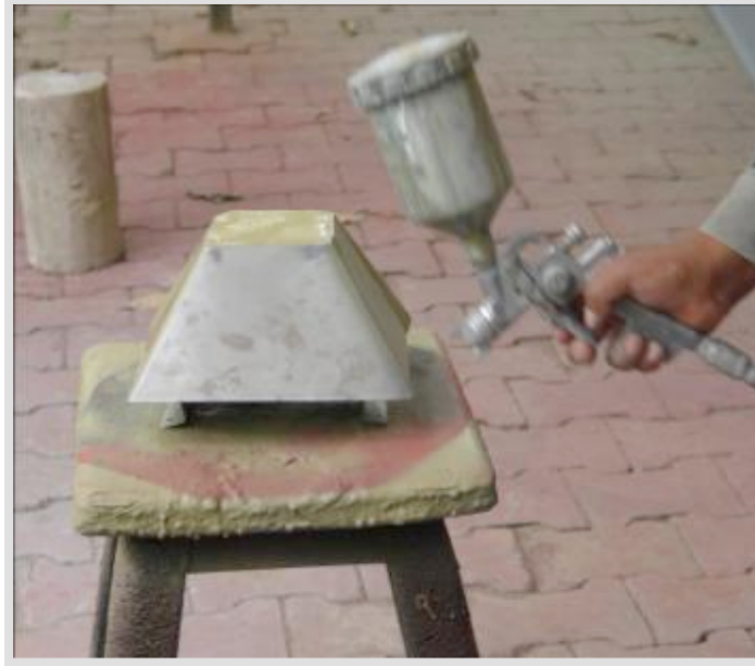
Fig. 5.8 Aplicación de recubrimiento.
