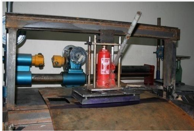
Fig. 4.22 Perforado para colocar compartimiento para termostato y puerta en el cuerpo de la carcasa.
