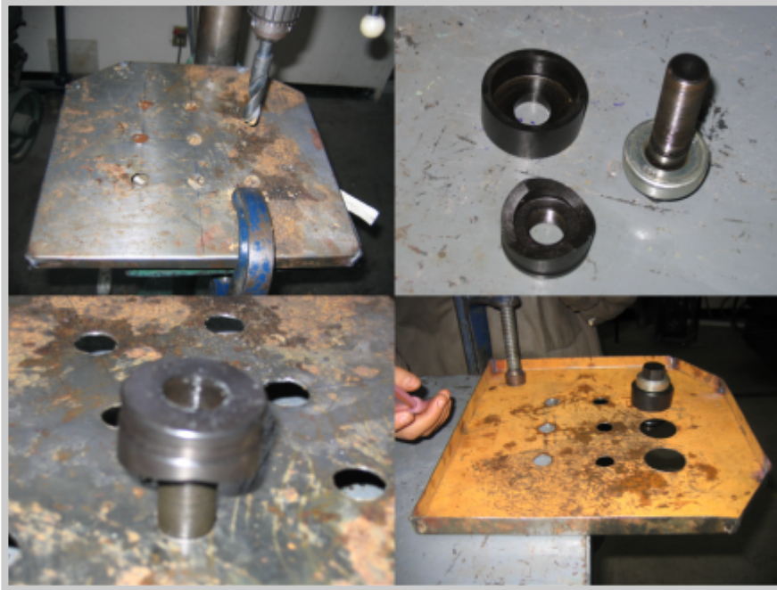
Fig. 5.5 Perforado con sacabocados.
