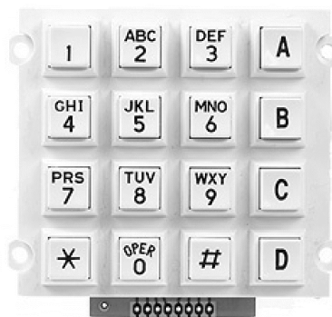
Figura A.3. Teclado matricial de 4x4 interruptores.
