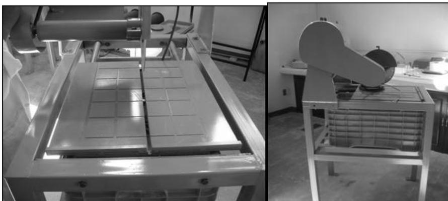
Figura 2.7.- Máquina de corte a diamante para cortes finos.
