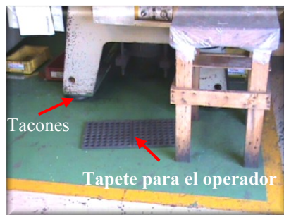
Fig. 4.4 Equipo de seguridad contra las vibraciones
