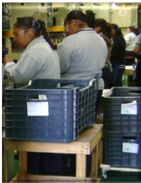
Fig. 4.22 Ubicación incorrecta de la mesa Fuente: Elaboración propia
