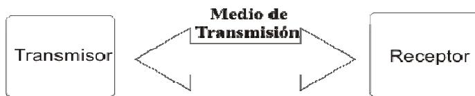
**Figura 2.1.** Diagrama de bloques para un sistema de comunicaciones electrónicas.
