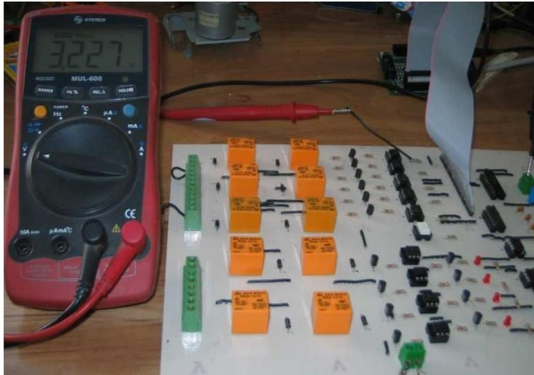
**Figura 4.5** Prueba realizada a la etapa de acoplamiento para el monitoreo del estado del interruptor.
