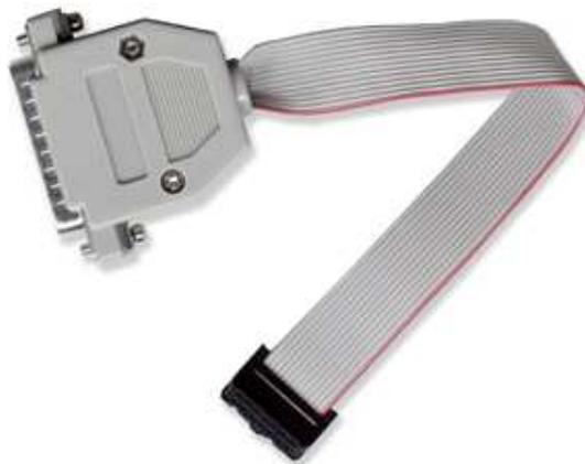
**Figura 2.6** Programador JTAG para la descarga de programas
