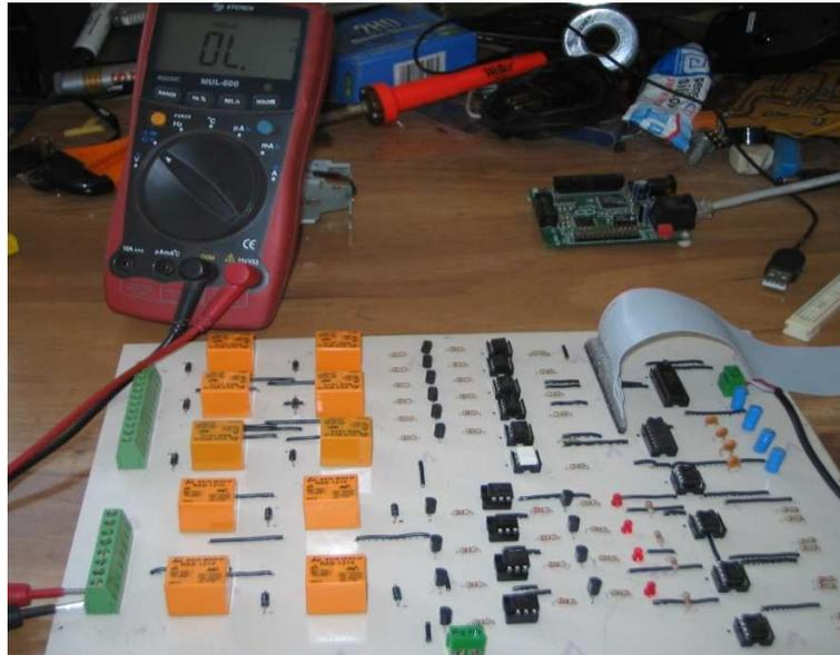
**Figura 4.6** Prueba realizada a la etapa de acoplamiento para la ejecución del mando *Bloquear*.
