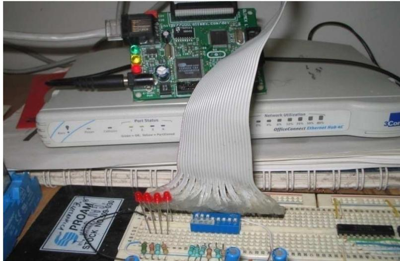
**Figura 4.4** Circuito de prueba para simular los cambios de estado de los parámetros del interruptor y observar su correcta señalización en la página de interfaz de usuario.
