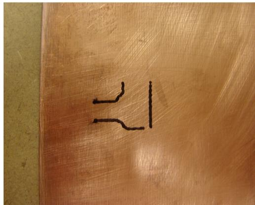
Figura 41. Circuito impreso del circuito RC dibujado por el sistema electromecánico.
