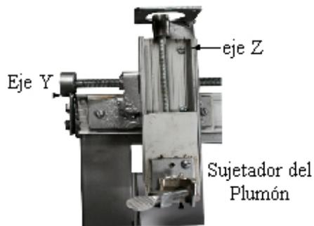
Figura 32. Herramienta que sujetará el plumón.
