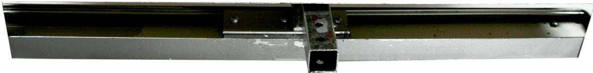
Figura 26. Canal en donde se deslizará el eje X.
