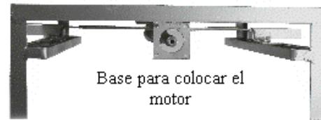
Figura 29. Base del Motor.
