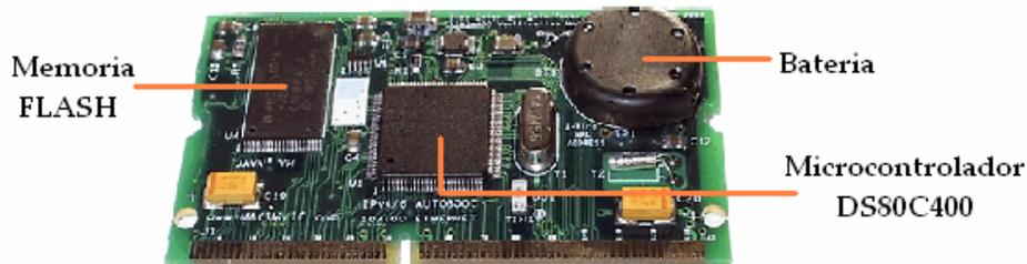
Figura 2.11. Módulo del microcontrolador DS80C400.
