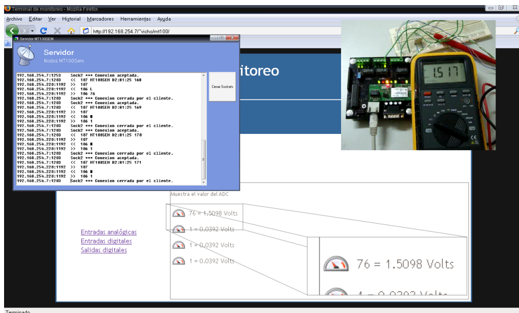
Figura 2.26. Lectura de un valor analógico en el nodo y resultado en la GUI.
