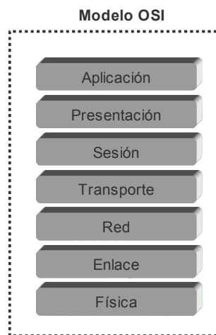
Figura 1.6. Capas del modelo OSI [49].
