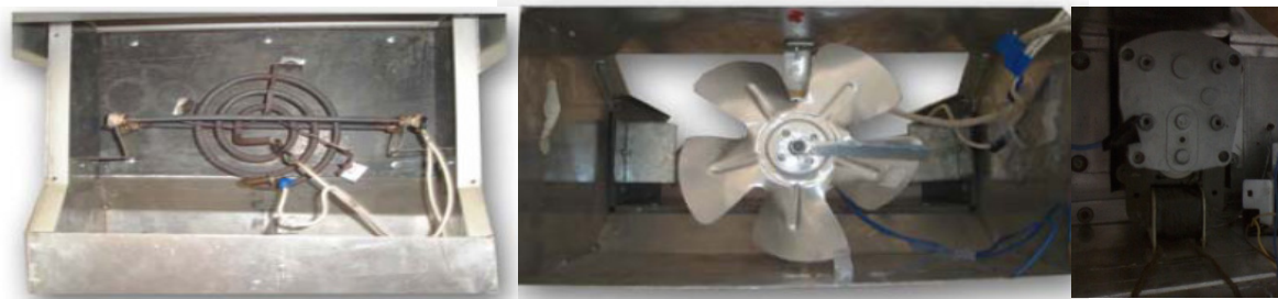
Figura 19. Actuadores presentes en el horno (resistencias, ventilador y motor)
